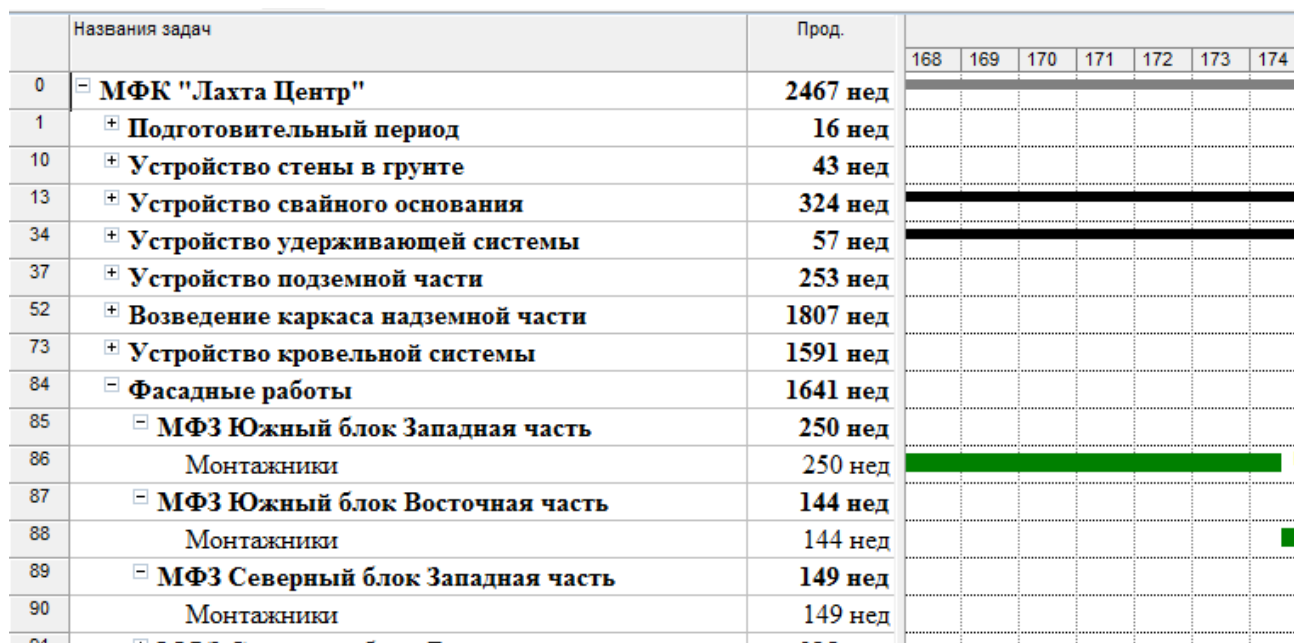
Рисунок 2.13 – Фрагмент календарного графика с максимальными сроками строительства МФК «Лахта Центр»
