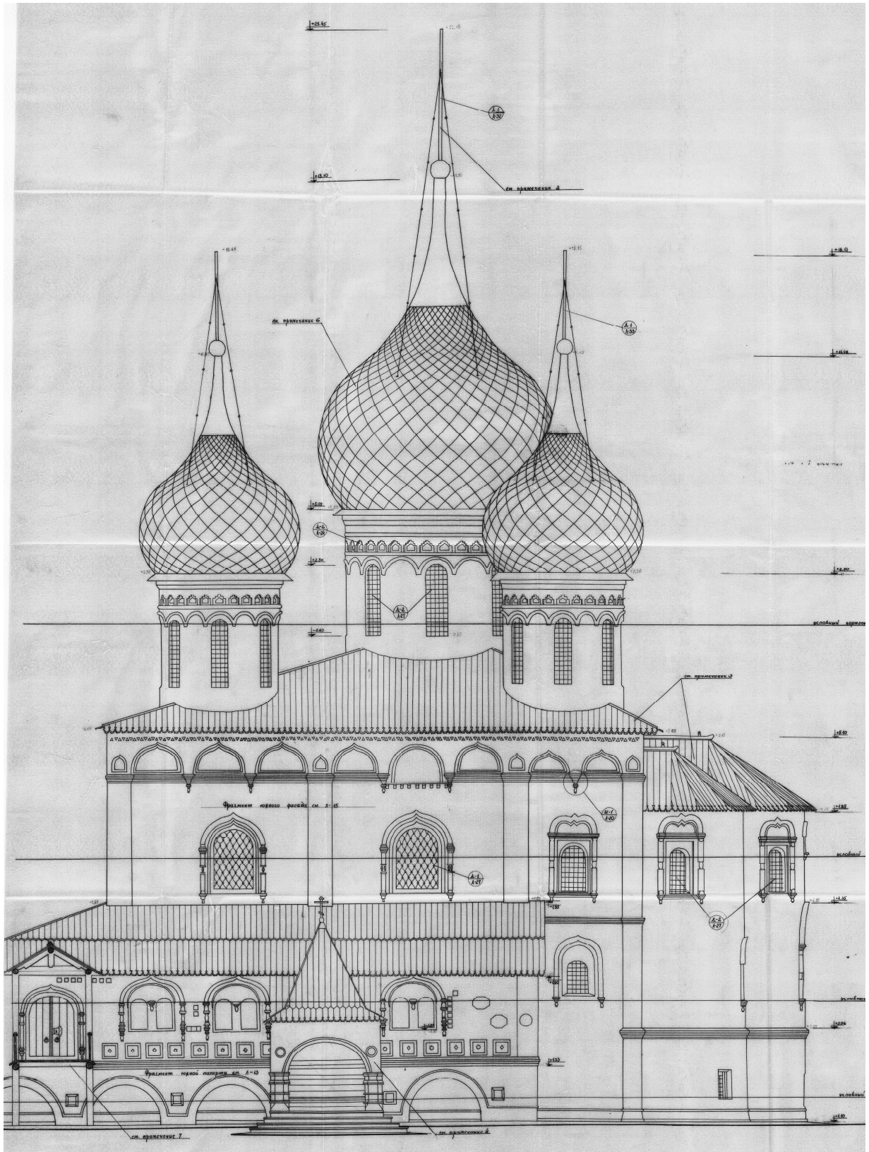
Рис. 2.33. Фрагмент чертежа проекта реставрации Троицкого собора Александрo-Свирского Троицкого монастыря. Автор – А.Н. Милорадович. Архив ОАО СПб НИИП «НИИ Спецпроектреставрация». – Д. 1187, с. 14..
