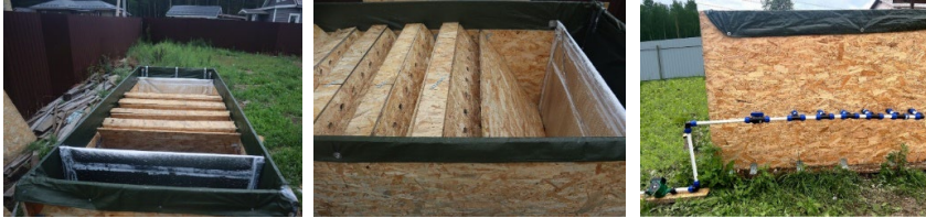
Рисунок 18 – Фотографии полупроизводственной установки отстойника с тонкослойным модулем новой конструкции
