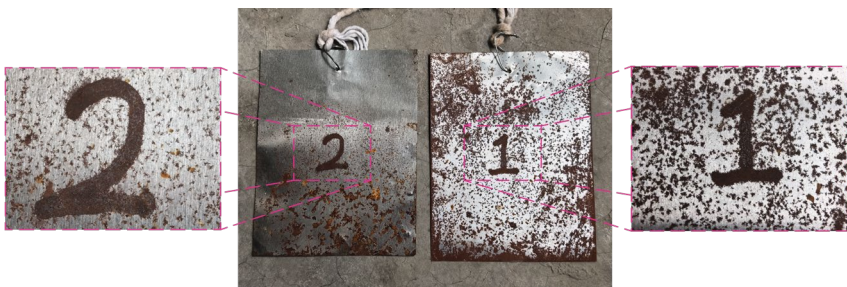
Рисунок 16 – Сравнение образцов из низкоуглеродистой стали: 1 – колодец без технологического оснащения, 2 – колодец с сифонным стояком
