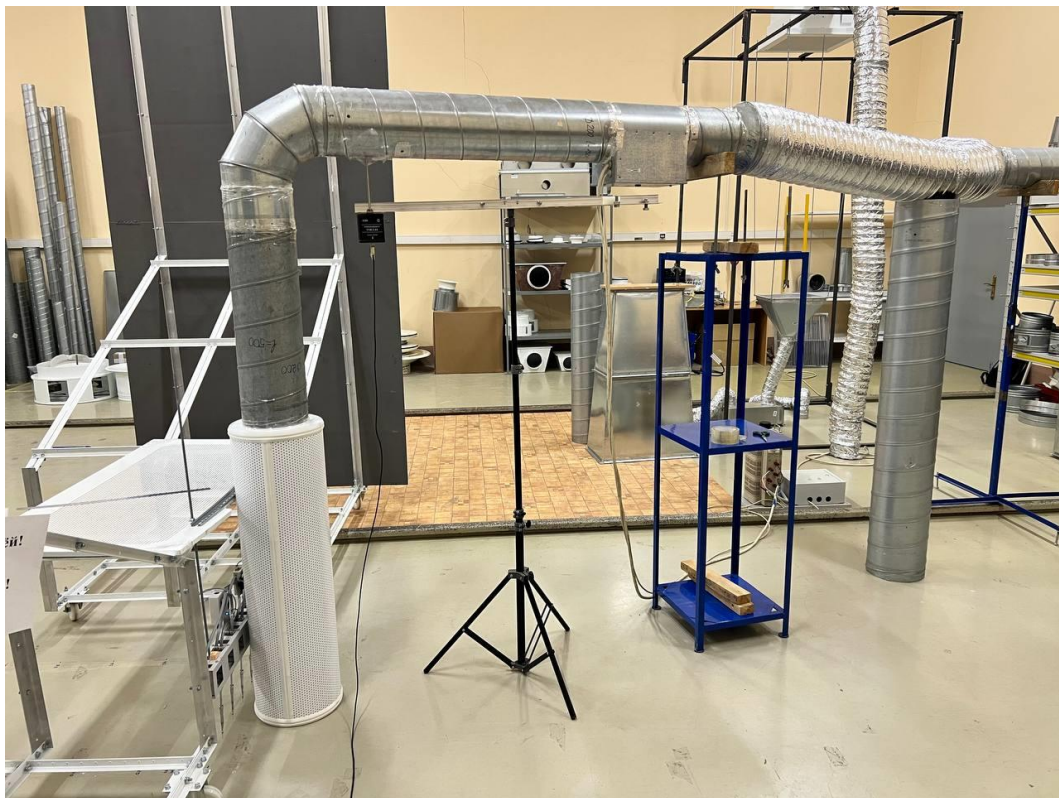
Рисунок 3.4 – Аэродинамический стенд для испытания диффузора 1ВНК
