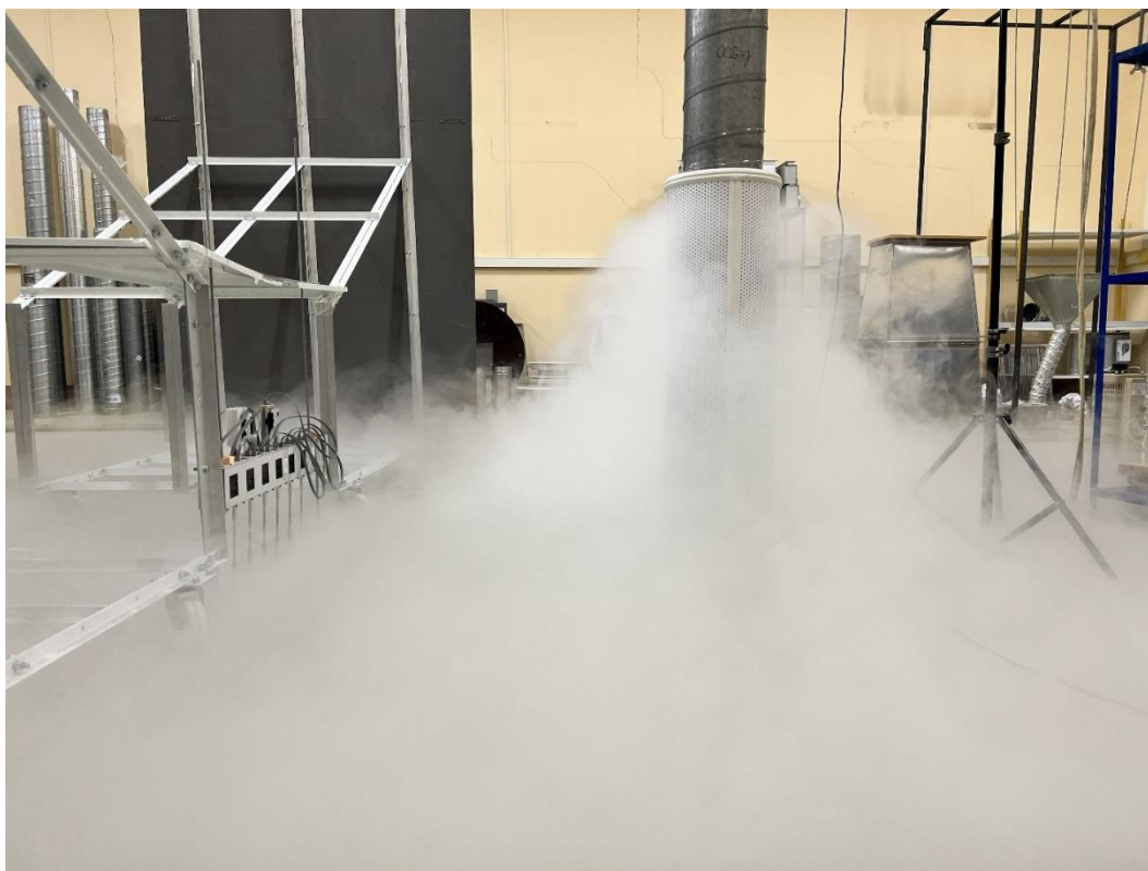
Рисунок 3.5 – Визуализация истечения из воздухораспределителя с помощью задымления
