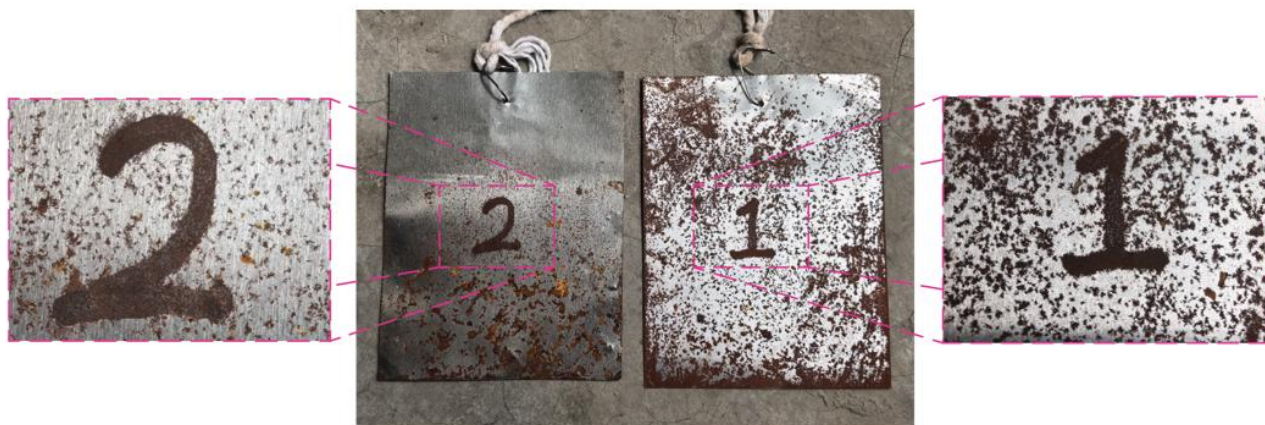
Рисунок 3.14. Сравнение образцов из низкоуглеродистой стали; 1 – колодец без технологического оснащения, 2 – колодец с сифонным стояком
