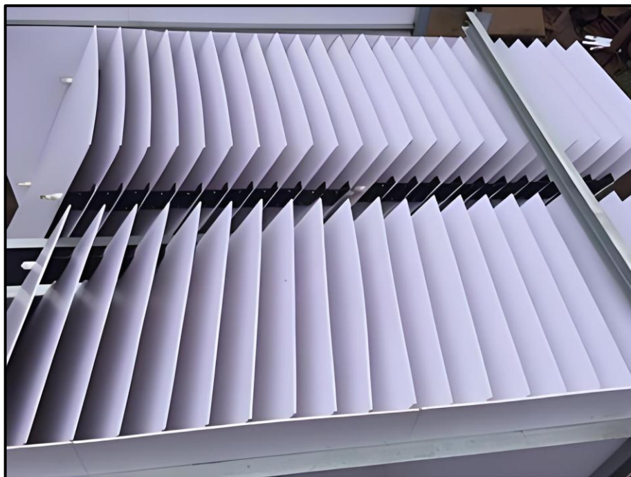
Рисунок 1.2 Конструкция тонкослойного модуля
