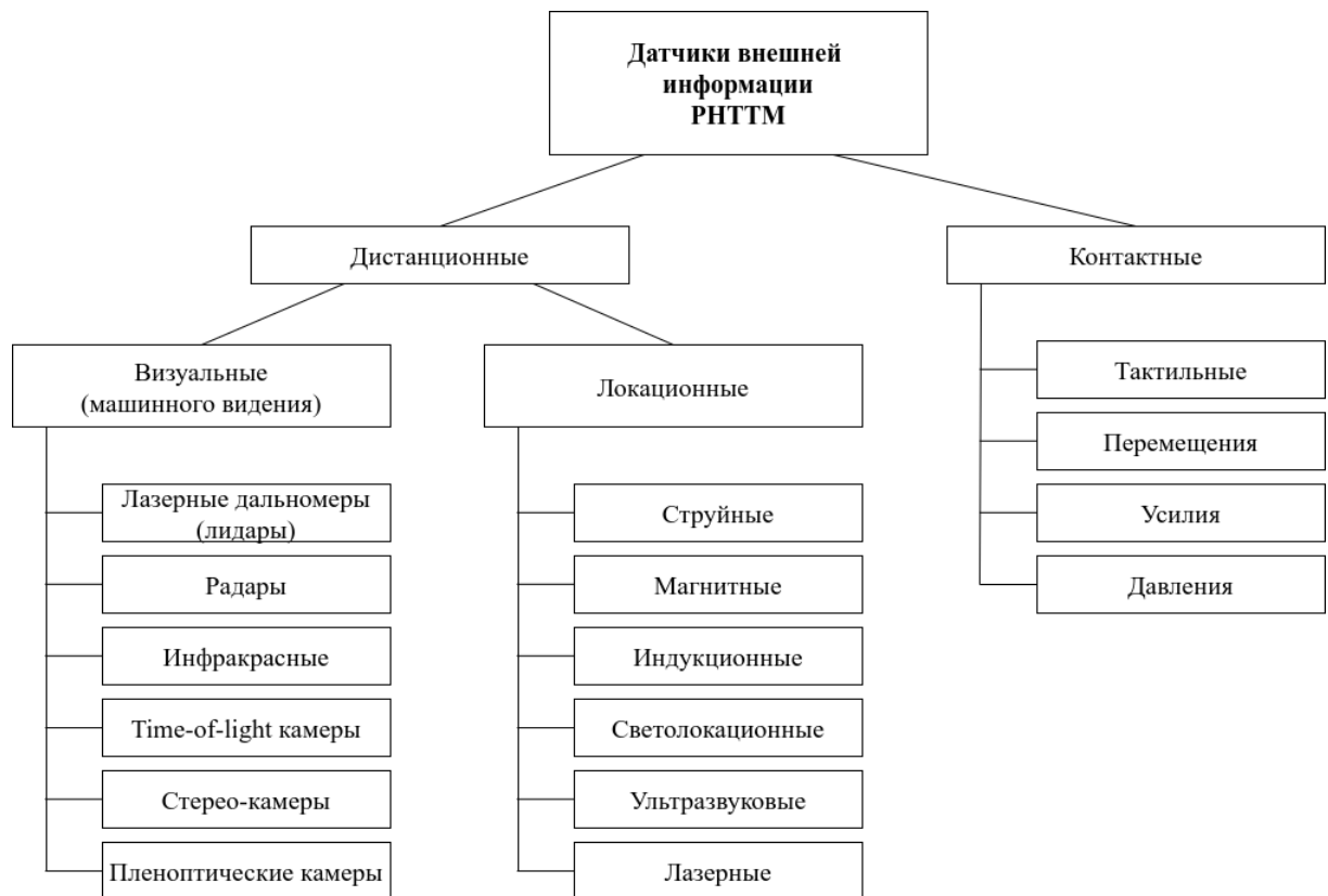
Рисунок 1.10 — Классификация датчиков внешней информации РНТТМ
