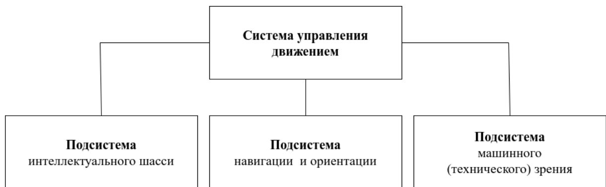
Рисунок 1.3 — Подсистемы автоматизированной системы управления BTC
