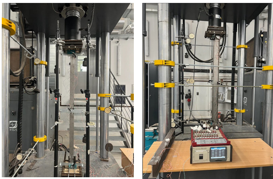
Рисунок 4.7 Образец в испытательной машине Newtons 1000 готовый к испытаниям
