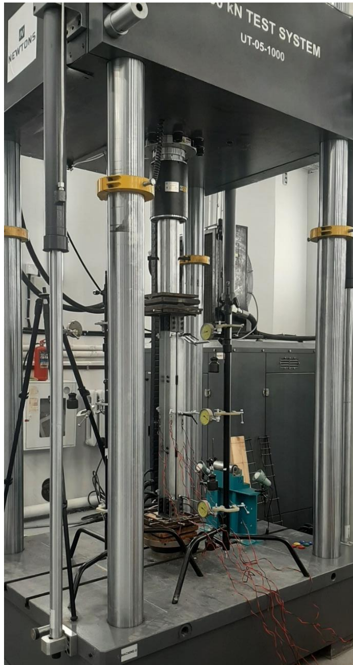
Рисунок 4.19 – Общий вид испытательной установки с образцом «Ш-1100»
