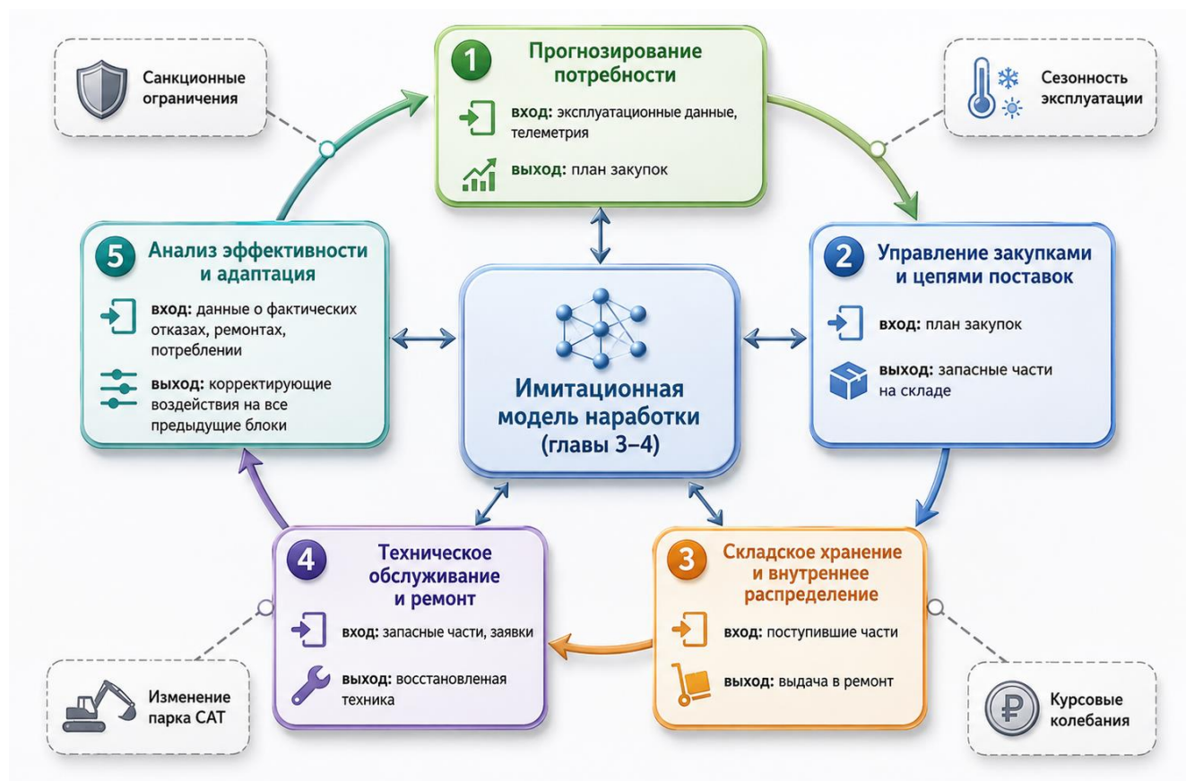
Рисунок 5.5 - Блок-схема комплексной системы обеспечения техники запасными частями
