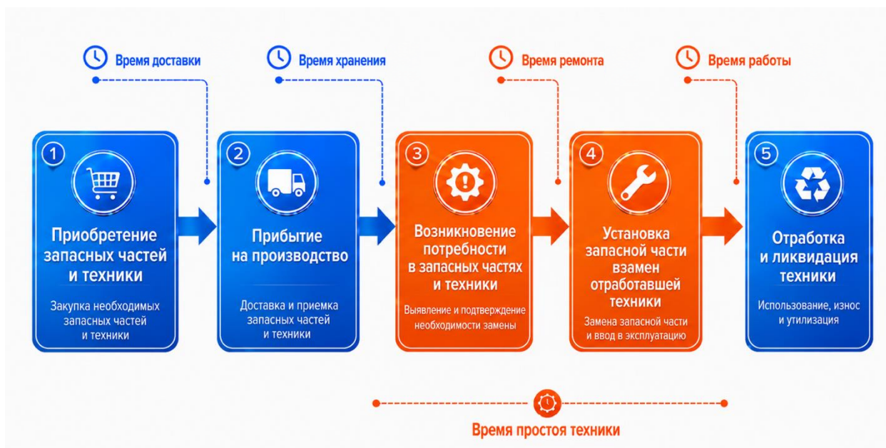
Рисунок 2.1 – Жизненный цикл деталей в рамках предприятий, эксплуатирующих специальную автомобильную технику в аэропортах
