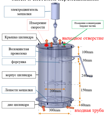
Рисунок 12 – Схема конструкции пылеулавливающего цилиндра
