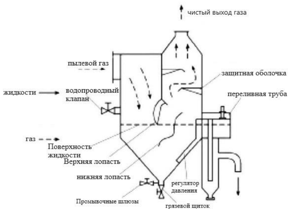
Рисунок 1.2 – Пылеуловитель гравитационного типа
