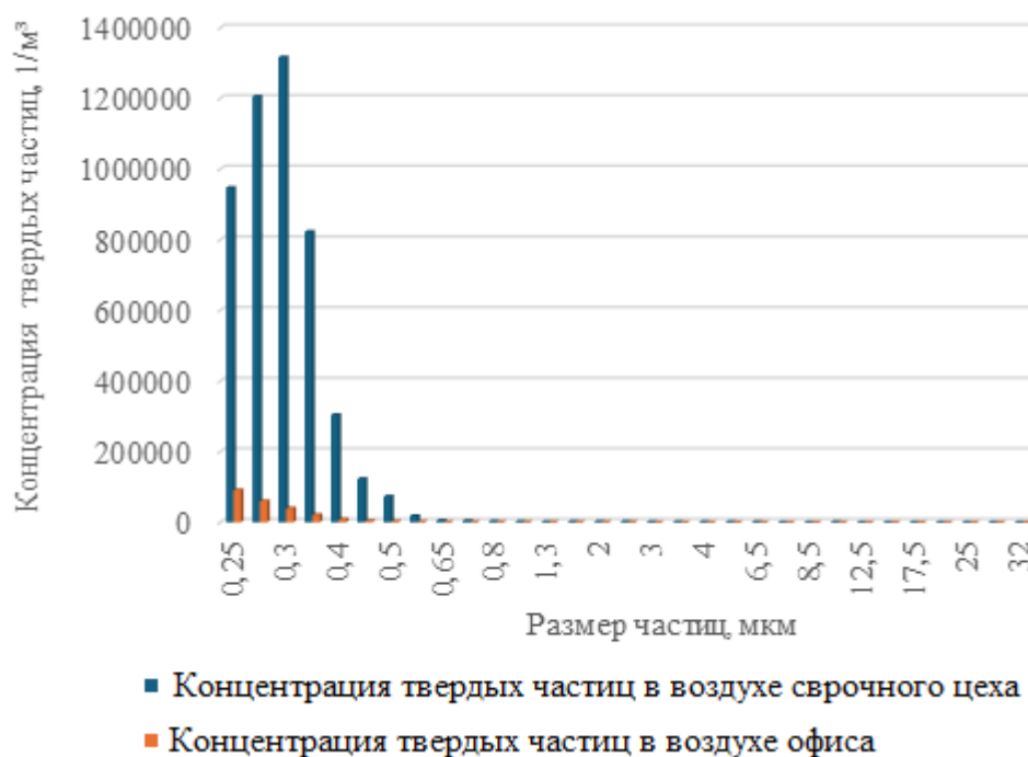
Рисунок 2.2 – Распределение концентрации твердых частиц сварочного аэрозоля по размерам
