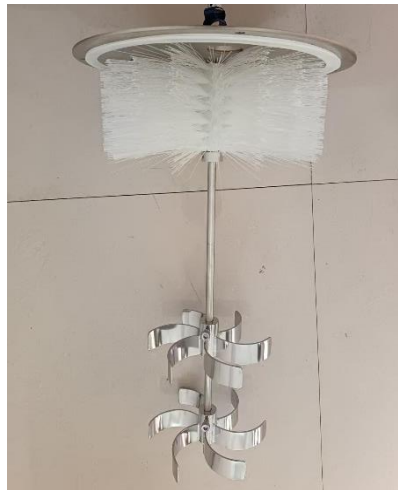
Рисунок 3.7 – Фотография перемешивающей лопасти и туманоулавливающей волоконной нити
