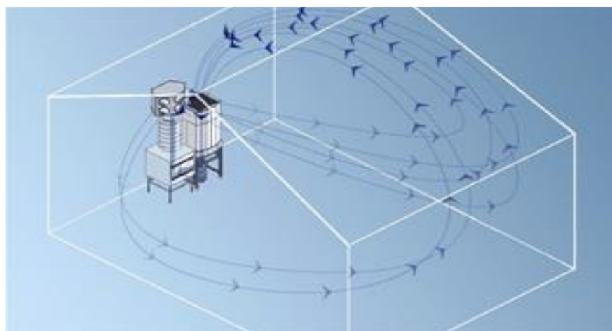
Рисунок 1.12 – Схемы систем общеобменной вентиляции Diluter. Стрелками показано направление движения воздуха
