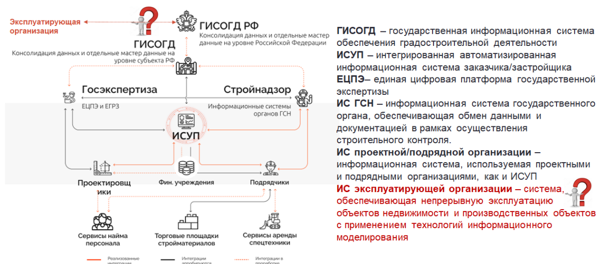
Рисунок 64 – Схема цифровой вертикали строительной отрасли
