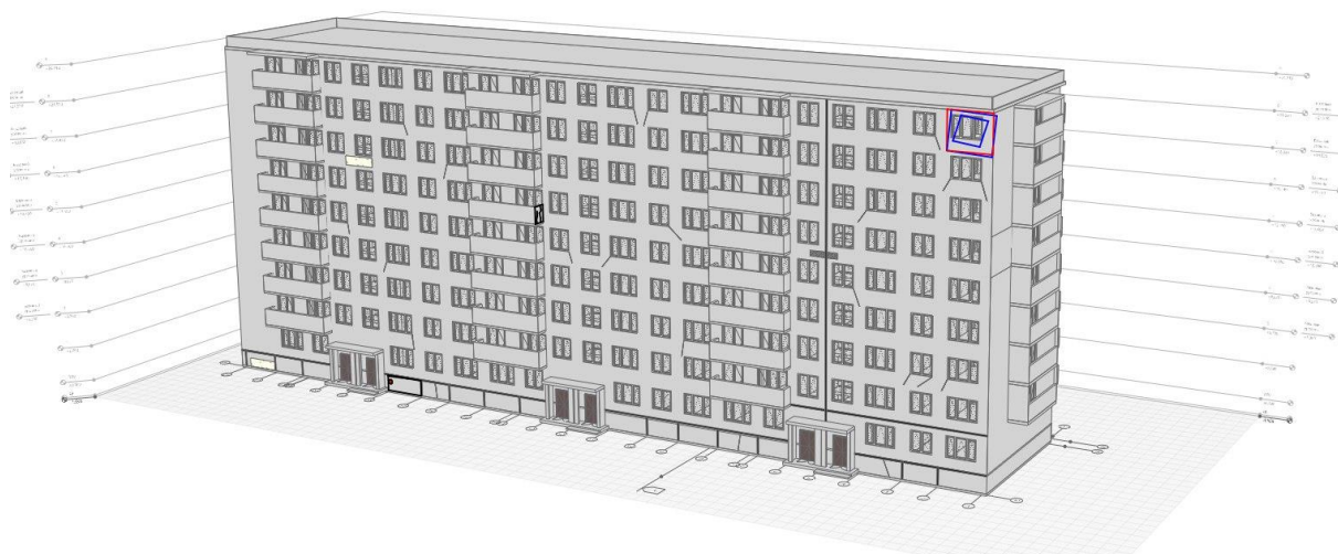
а) Фиксация дефектов на ЦИМ в виде геометрических пространственно-ориентированных элементов
