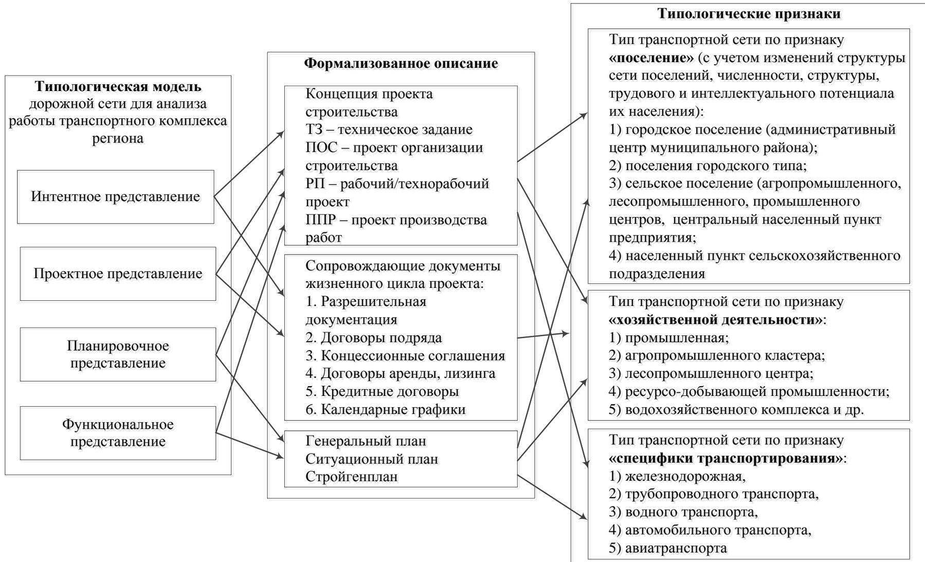
Рисунок 2.1 – Применение типологических моделей транспортной сети (МТС) для проектирования дорожной сети
