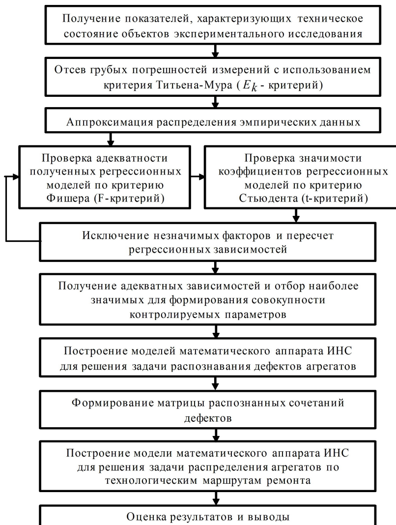
Рис. 3. Схема методики математической обработки эмпирических данных для построения моделей ИНС
