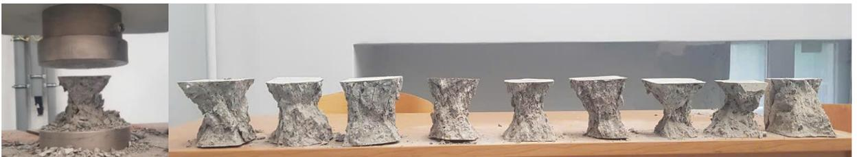
Рисунок 2.18 – Картинки разрушения бетонных образцов-кубов на сжатие
