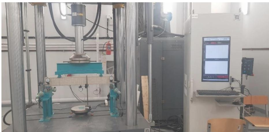
Рисунок 2.20 – Универсальная машина UT-05-1000 в процессе испытания железобетонной балки
