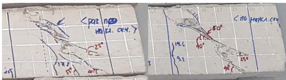
Рисунок 2.36 – Раздробление бетона по наклонному сечению при испытании балки
