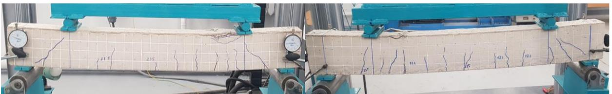
Рисунок 2.32 – Разрушение балки ЖБ2-3-1
