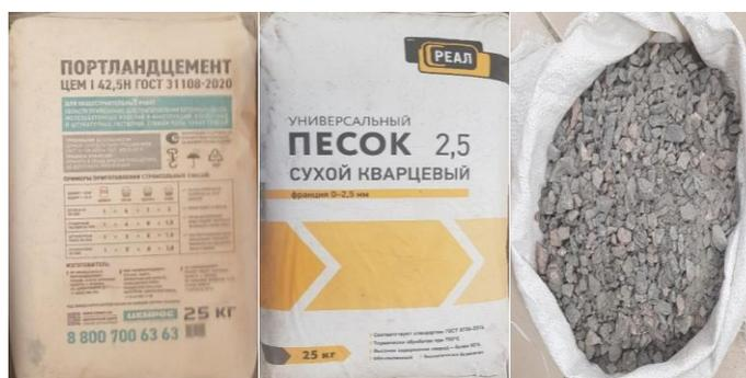
Рисунок 2.9 – Цемент, песок и камень для бетона
