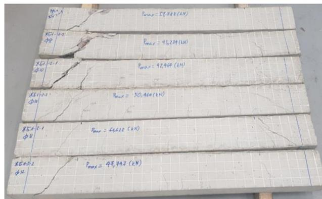
Рисунок 2.24 – Образцы серии 1 после испытания
