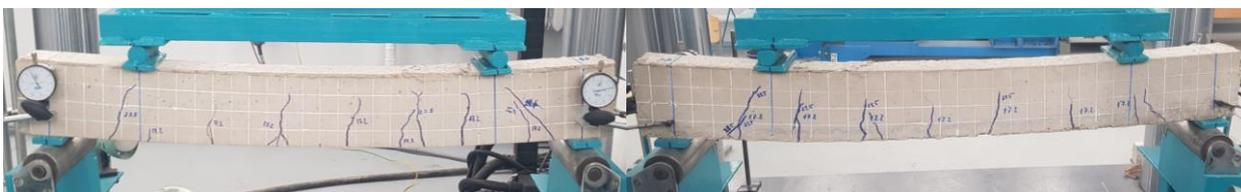
Рисунок 2.28 – Разрушение балки ЖБ2–1–2
