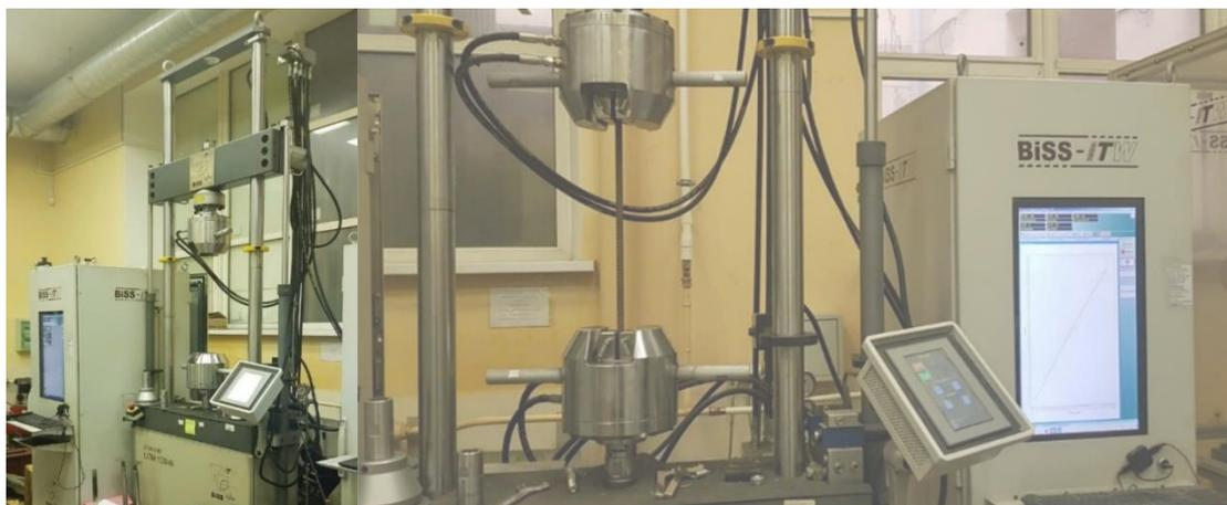
Рисунок 2.13 – Общий вид машинного UT–04–0100 и арматурного стержня при испытании на растяжение
