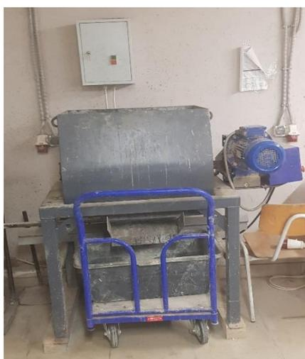
Рисунок 2.10 – Бетоносмеситель БП-1Г-100.00.000 ПС
