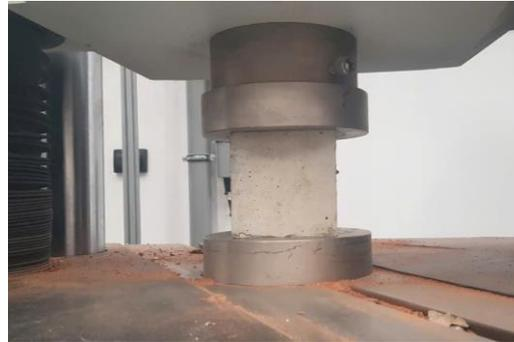
Рисунок 2.17 – Образцы бетонных кубов при испытании на сжатие
