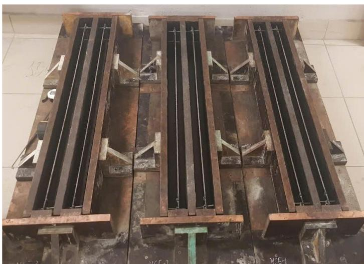
Рисунок 2.7 – Опалубки для экспериментальных образцов балок
