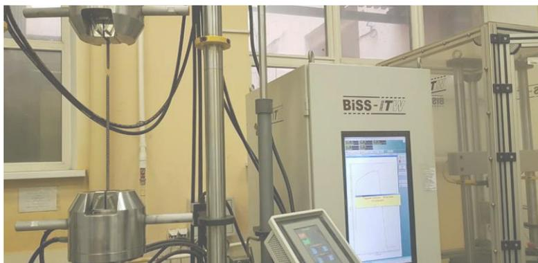
Рисунок 2.15 – Испытание на определение прочности арматуры при растяжении
