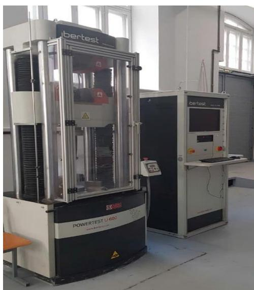
Рисунок 2.14 – Испытательная машина Powertest U–600 от Ibertest
