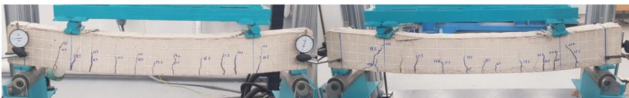
Рисунок 2.27 – Разрушение балки ЖБ2–1–1
