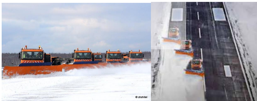
Рисунок 1.3 – Пример круговой схемы очистки покрытия
