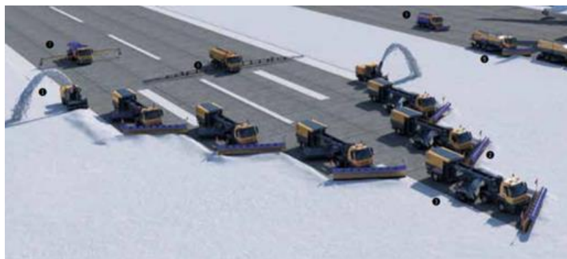
Рисунок 1.4 – Пример уборки снега «клином»
