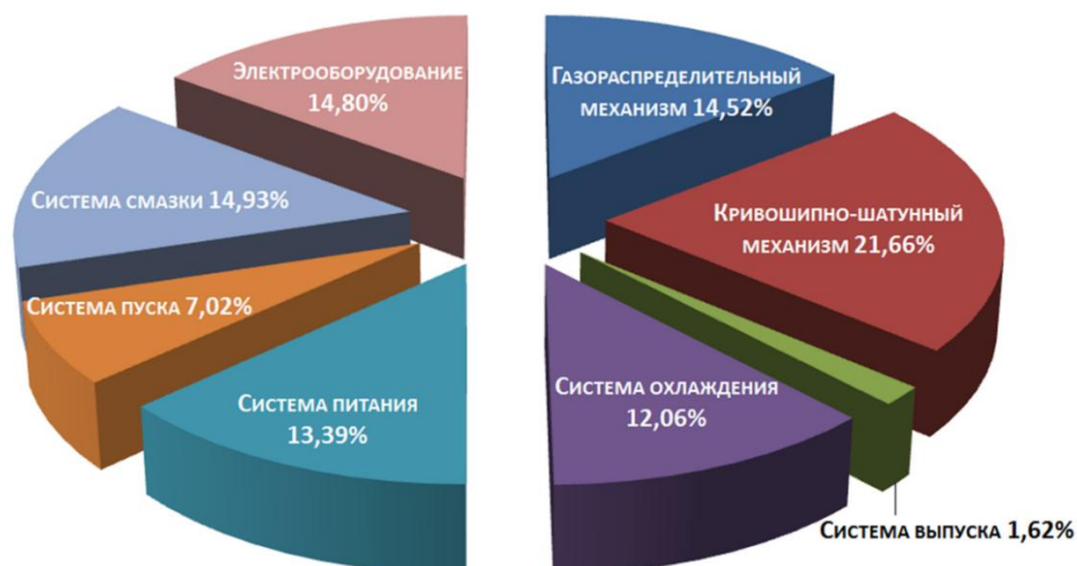
Рисунок 2.16 – Причины и их структура потери работоспособности электрооборудования и систем двигателя грузовой техники КАМАЗ в первый год эксплуатации.
