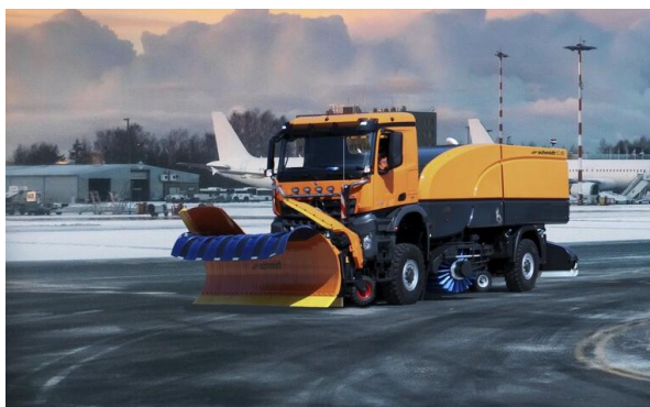
Рисунок 1.15 – Аэродромная плужно-щеточно-продувочная машина SCHMIDT CJS
