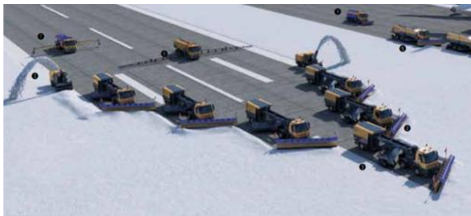
Рисунок 1.2 – Пример уборки снега “клином”
