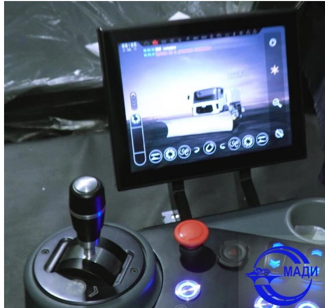
Рисунок 4.3 – Система управления навесным оборудованием, установленная в кабине оператора уборочного автомобиля
