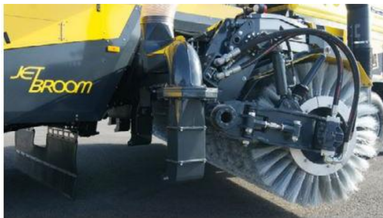
Рисунок 1.18 – Щетка центральная в составе специальной машины Boschung JETBROOM 10000-A
