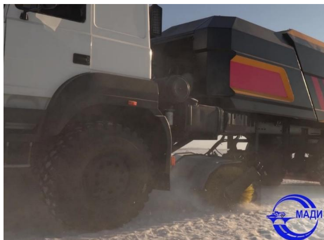
Рисунок 4.6 – Рабочее положение щетки центральной при движении по испытательному полигону
