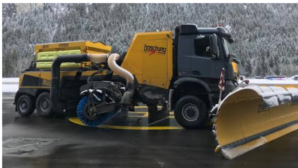
Рисунок 1.17 – Аэродромная подметально-продувочная машина Boschung JETBROOM 10000-A
