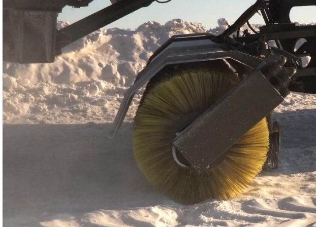
Рисунок 4.5 – Проведение эксплуатационных испытаний по определению частоты вращения щетки центральной аэродромного уборочного автомобиля
