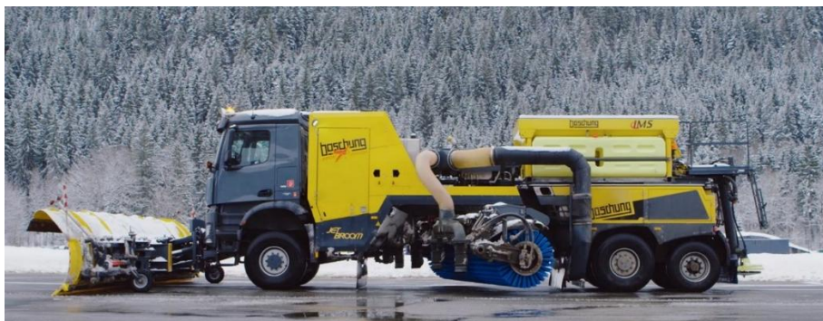
Рисунок 1.13 – Компактная подметально-продувочная машина с разнесенными мостами
