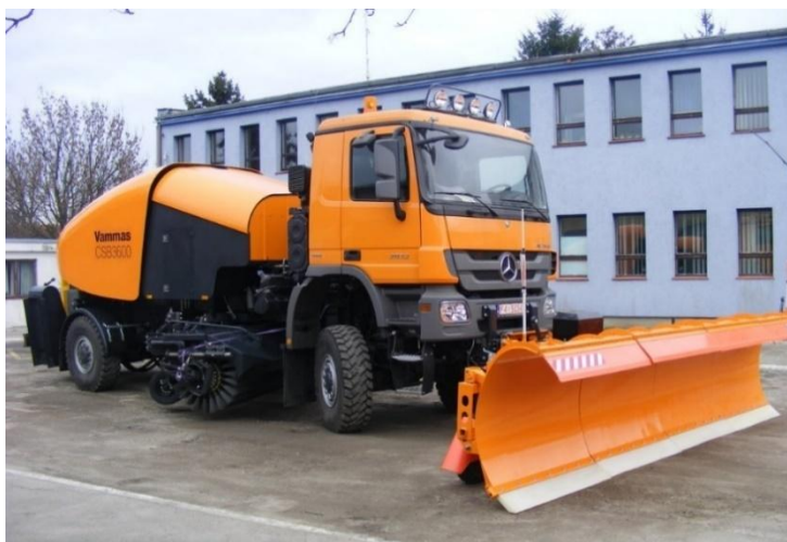
Рисунок 1.16 – Аэродромная подметально-продувочная машина VAMMAS CSB3600
