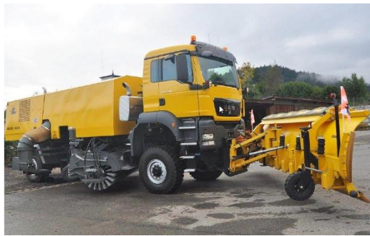
Рисунок 1.10 – Комбинированная подметально-продувочная машина
