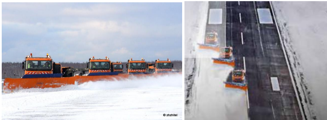
Рисунок 1.1 – Пример круговой схемы очистки покрытия
