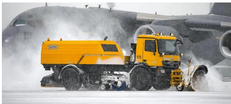
Рисунок 1.14 – Компактная аэродромная машина на базе специального автомобиля.
