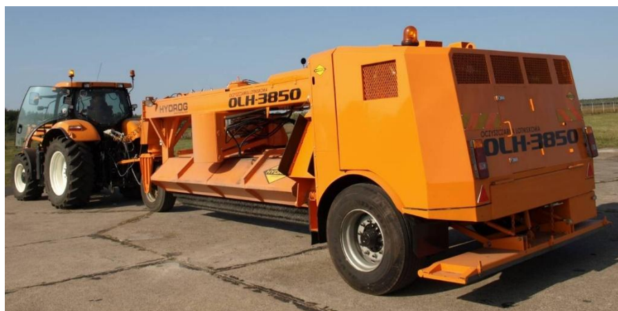
Рисунок 1.11 – Прицепная подметально-продувочная машина
