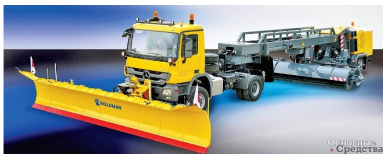
Рисунок 1.12 – Полуприцепная подметально-продувочная машина с седельным тягачом
