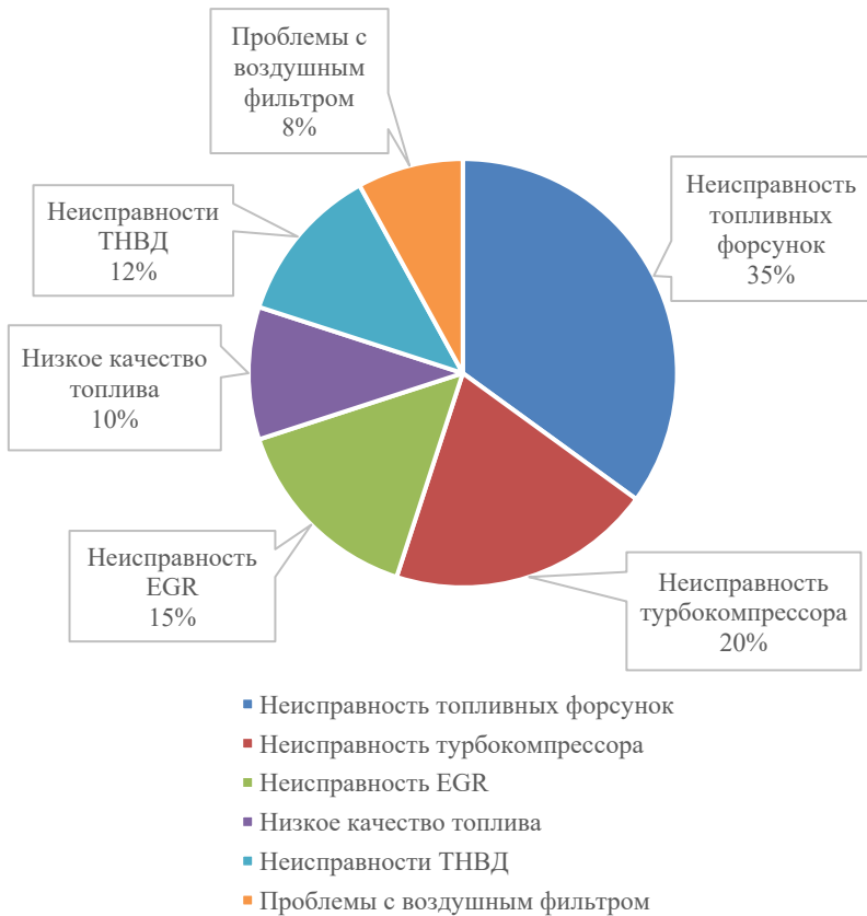
Рисунок 1 – Статистика причин повышения дымности у дизельных автомобилей с системой Common Rail (в процентах), основанная на анализе данных сервисных центров, технических исследований и экспертных оценок
