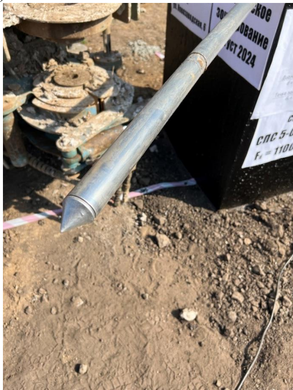
Рисунок 2.5 – Проведение статического зондирования грунта а) под уширением на этапе формирования уширения; б) вдоль боковой поверхности сваи и уширения после устройства сваи в пробитой скважине с уширением целиком
