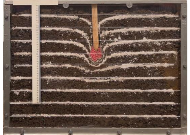
Рисунок 2.2 – Схема моделирования сваи в пробитой скважине с уширением в грунтовом лотке: а) пробивка скважины; б) скважина; в) засыпка щебня, создание уширения; г) модель сваи с уширением.
