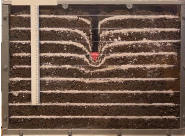
Рисунок 2.2 – Схема моделирования сваи в пробитой скважине с уширением в грунтовом лотке: а) пробивка скважины; б) скважина; в) засыпка щебня, создание уширения; г) модель сваи с уширением.
