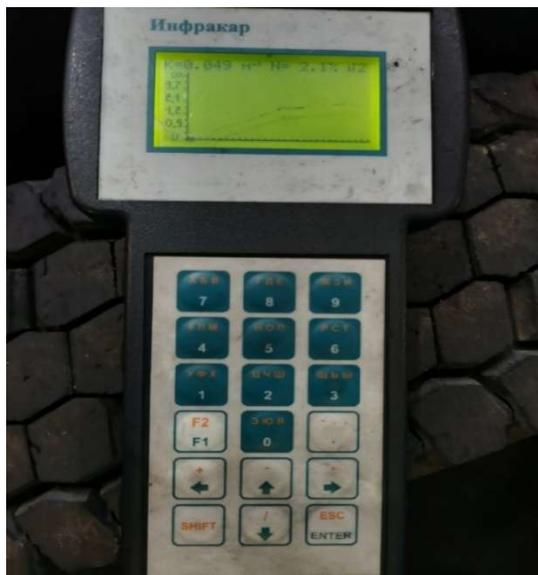
Рисунок 3.25 – Дисплей пульта для контроля результатов измерений.
