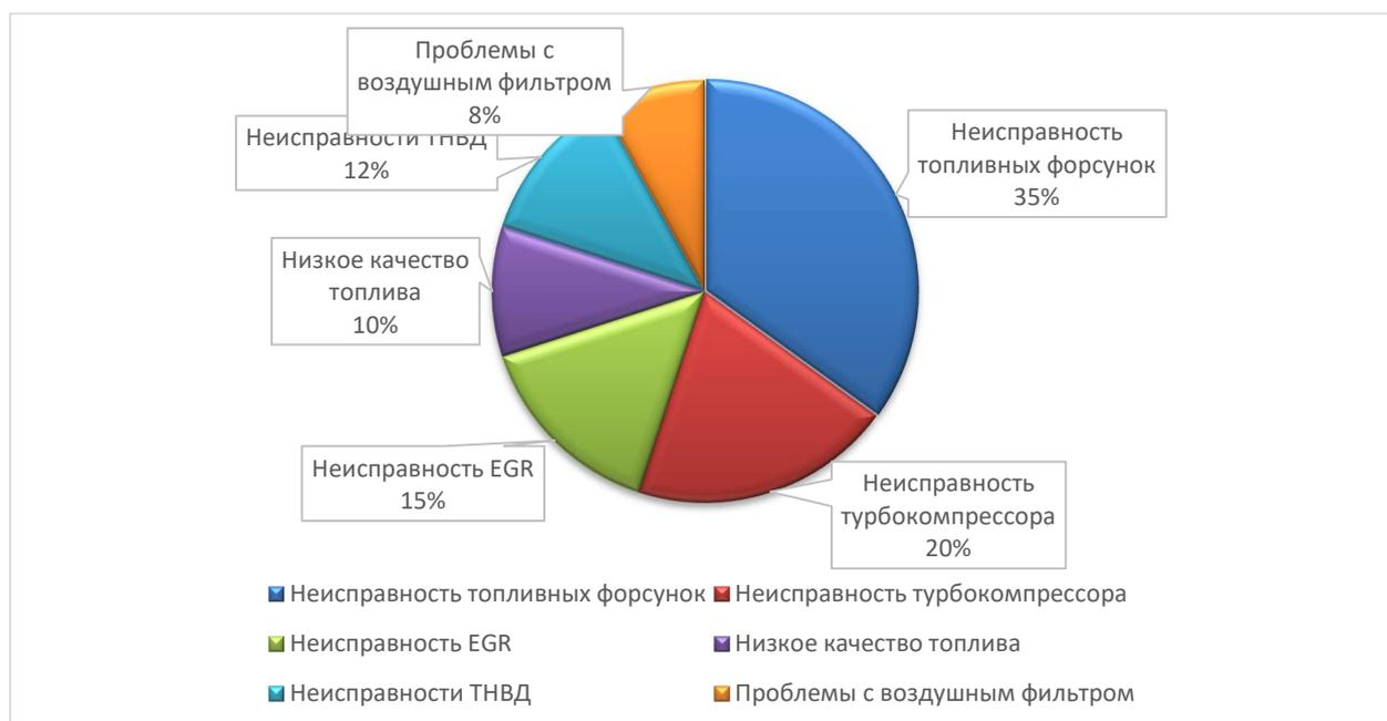
Рисунок 1.11 – Статистика причин повышения дымности у дизельных автомобилей с системой Common Rail (в процентах), основанная на анализе данных сервисных центров, технических исследований и экспертных оценок
