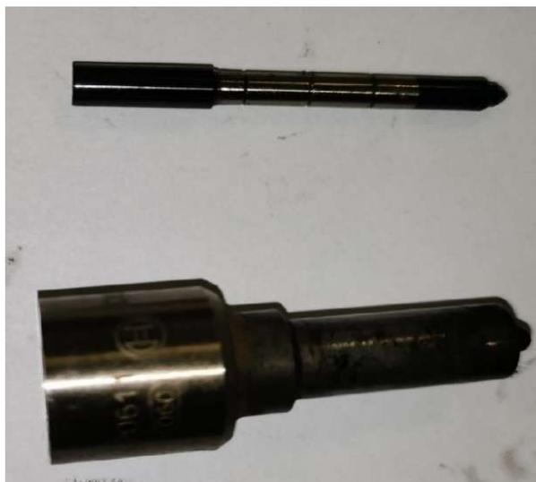
Рисунок 3.11 – Распылитель и игла исследуемой форсунки
