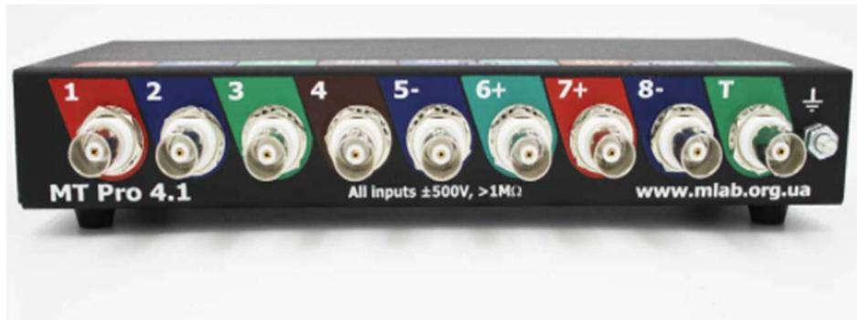
Рисунок 3.7 – Осциллограф МТ 4.1 Pro
