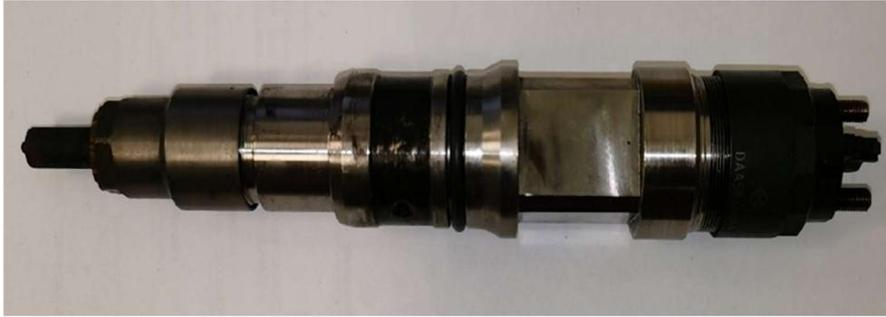
Рисунок 3.9 – Топливная форсунка исследуемого двигателя
