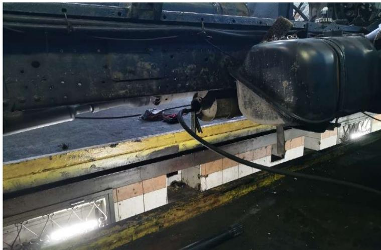
Рисунок 3.24 – Установка пробоотборного зонда дымомера
