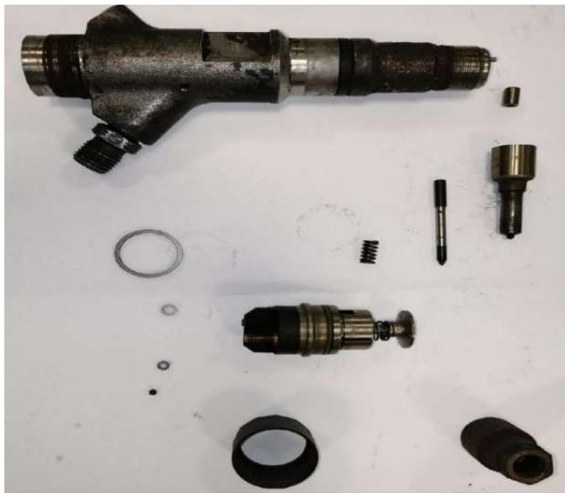
Рисунок 3.10 – Топливная форсунка исследуемого двигателя в разобранном виде
