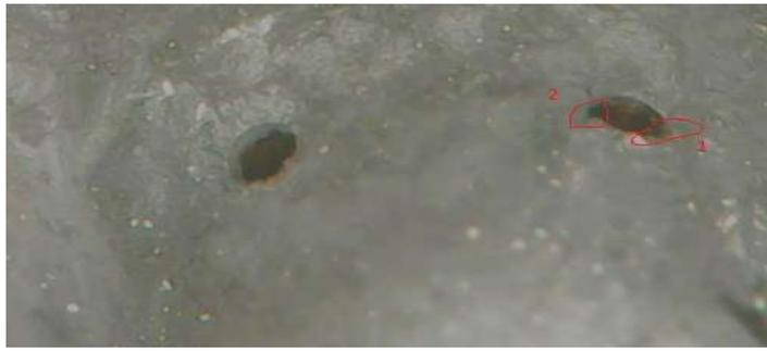
Рисунок 3.16 – Сопловое отверстие со следами износа распылитель №3
