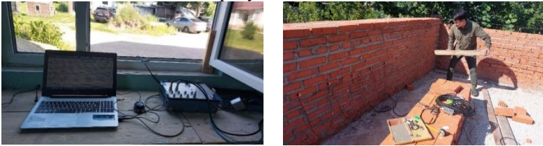
Рисунок 8. Проведение испытаний методом изгибных волн с измерительным комплексом и возбуждением с использованием тампера
