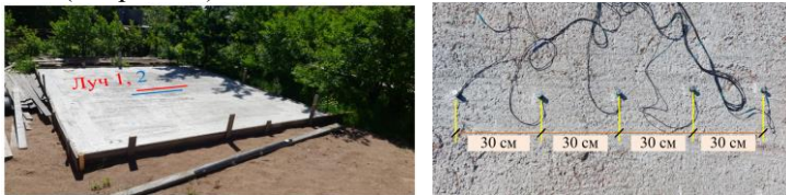
Рисунок 10. Фундаментная бетонная плита и датчики-акселерометры, установленные на ее поверхности
