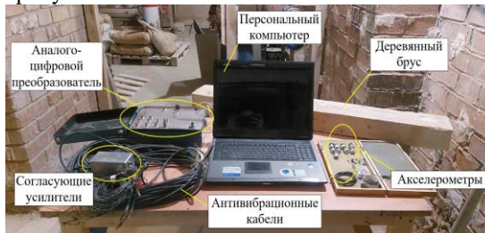
Рисунок 5. Датчики и регистрирующая аппаратура типового измерительного комплекса
