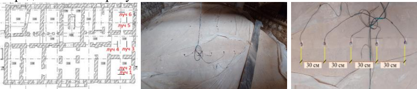
Рисунок 13. Участки проведения испытания и установки измерительного оборудования
