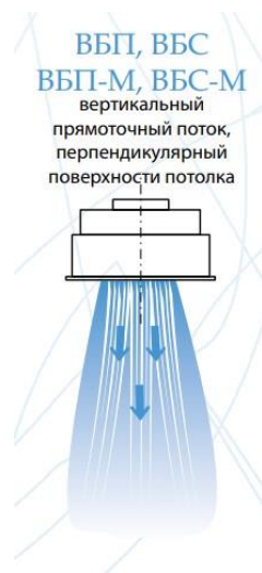
Рисунок А.1 – Схема подачи ламинарных однонаправленных воздушных потоков
