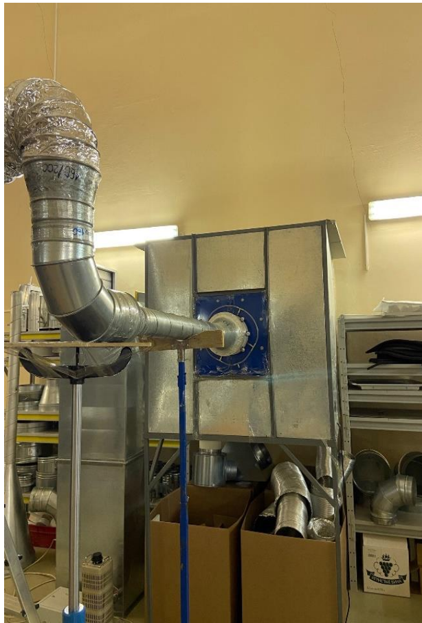
Рисунок Б.3 – Камера статического давления
