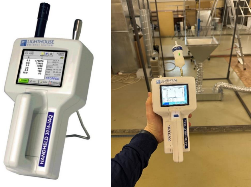
Рисунок 3.6 – Счётчик аэрозольных частиц «Handheld 3016-IAQ» с изокинетическим пробоотборником
