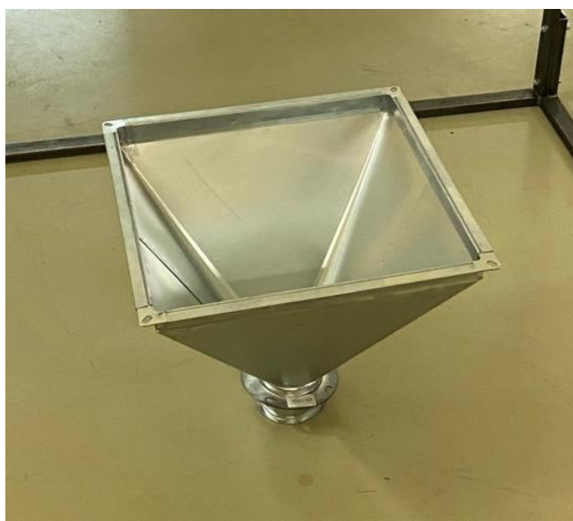
Рисунок Б.6 – Вентиляционная воронка, имитирующая поверхность гранулятора
