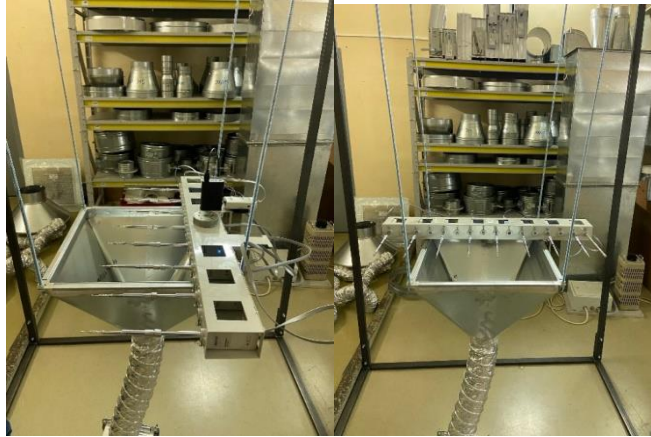
Рисунок 3.9 – Измерения скоростей воздуха по горизонтальной поверхности
