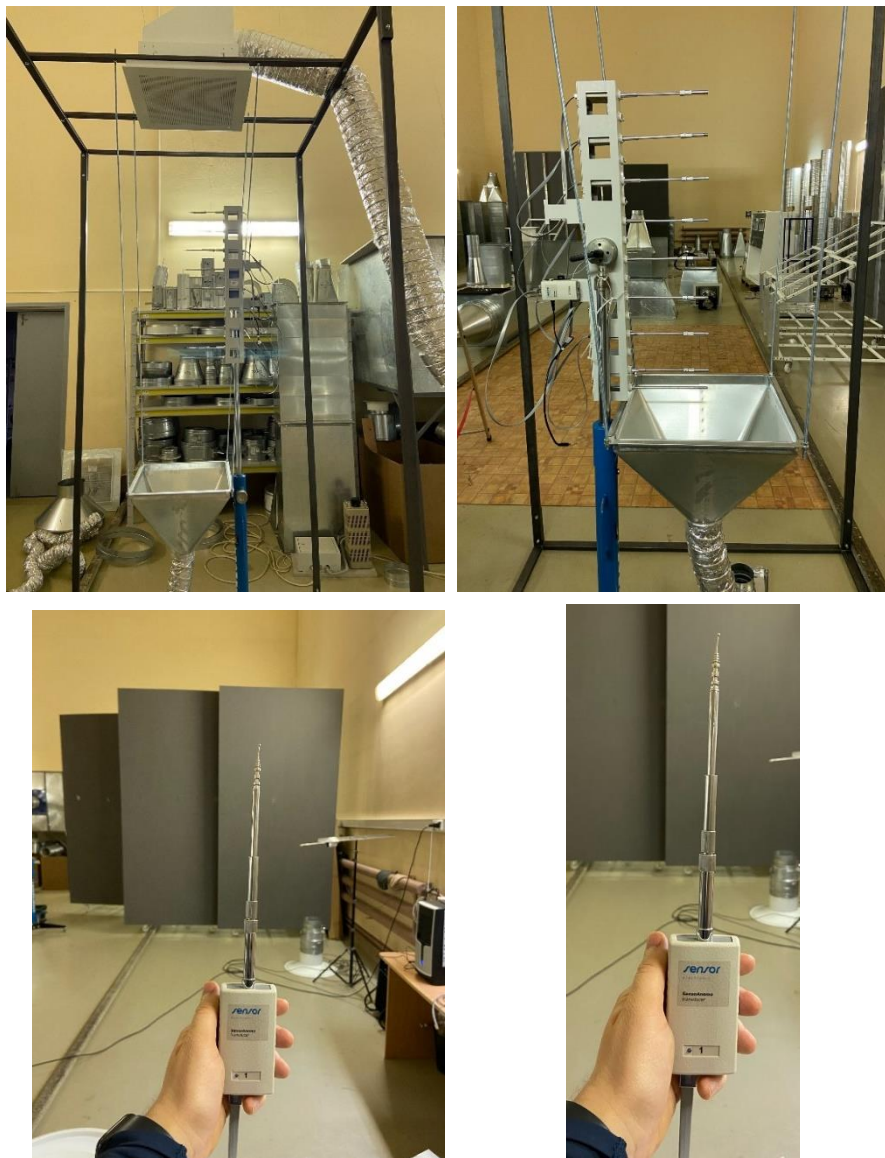
Рисунок 3.4 – Система измерений скорости воздуха с датчиками
