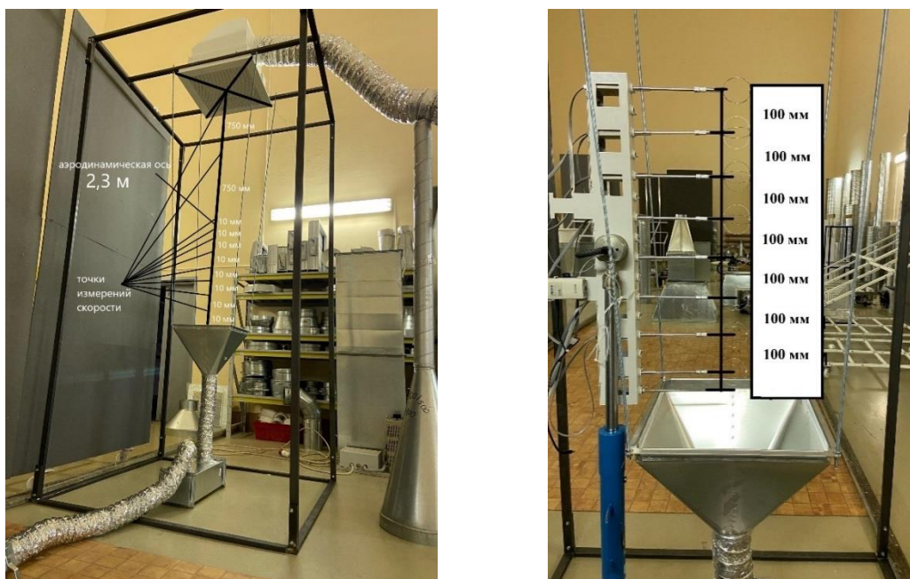
Рисунок 3.8 – Измерения скоростей движения воздуха на аэродинамической оси
