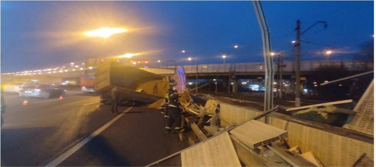
Рисунок 2.15 – Смещенный центр масс грузового транспортного средства – причина наезда на элементы дорожной инфраструктуры
