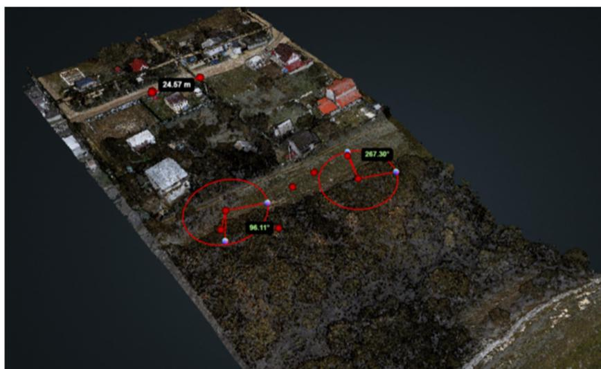
Рисунок 2.9 – Облако точек, полученное БПЛА с системой лазерного сканирования
