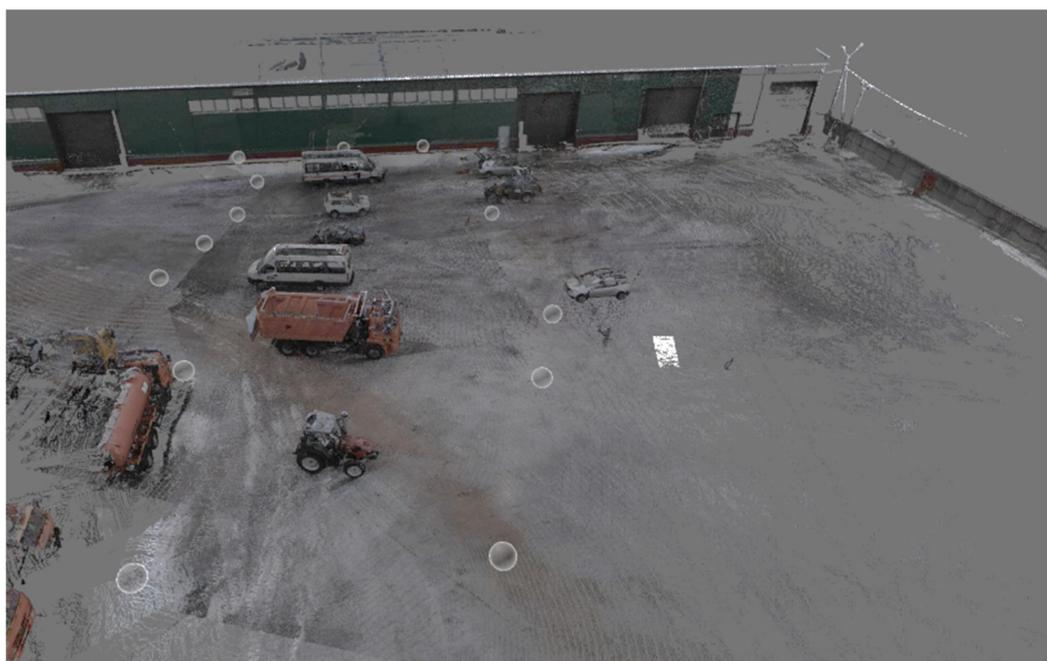
Рисунок 2.6 – Облако точек, деформированных транспортных средств после ДТП, созданных промышленным лазерным сканером (точность до 1 мм)
