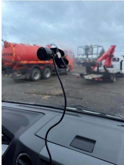
Рисунок 3.2 – Место крепления датчика в исследуемом транспортном средстве
