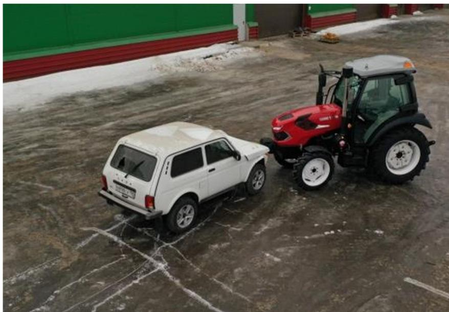
Рисунок 2.2 – ДТП (Угол взаимного расположения транспортных средств – острый)
