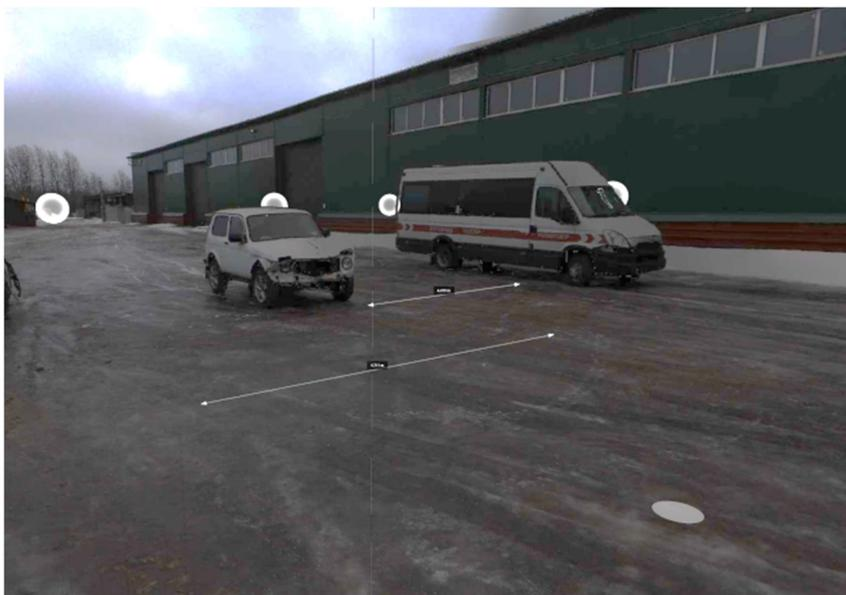
Рисунок 2.8 – Возможность определения расстояния между транспортными средствами с помощью программного обеспечения, созданным промышленным лазерным сканером
