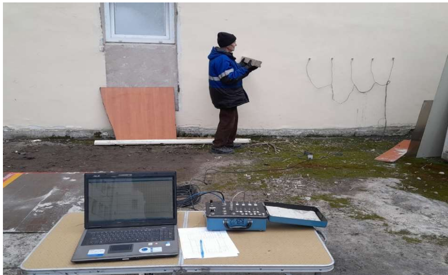
Рисунок 4.17. Схема проведения испытаний с измерительным комплексом
