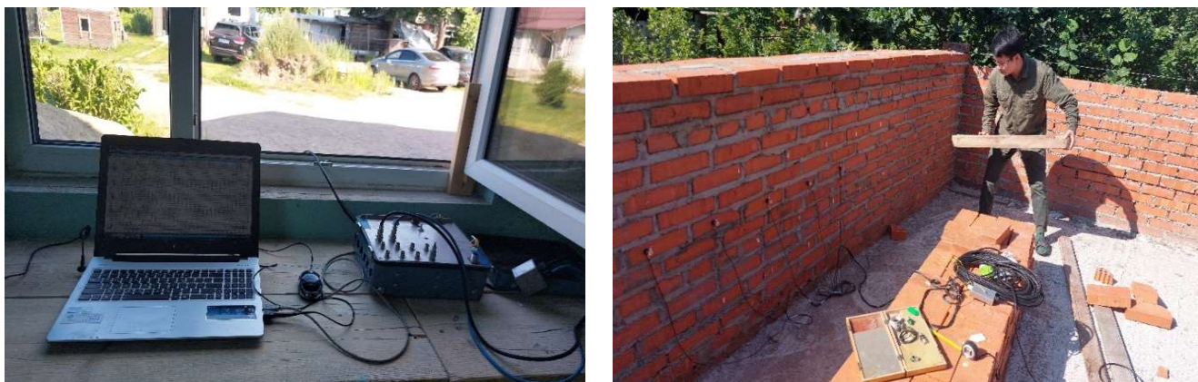
Рисунок 4.13. Проведение испытаний методом изгибных волн с измерительным комплексом и возбуждением с использованием тампера
