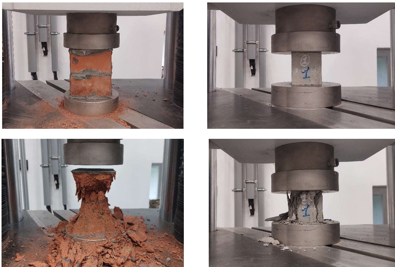
Рисунок 4.12. Экспериментальные образцы кирпича и растворного кубика до и после проведения испытания
