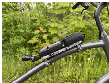
Рис.4. Конструкция крепления деселерометра модели «LWS-2MC» (вид сбоку)
