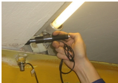
Рисунок 5 – Передача исследуемому объекту механической энергии генератором ударных импульсов
