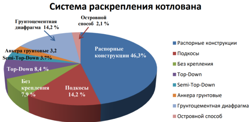
Рис. 3. Анализ применяемых систем раскрепления котлованов в плотной городской застройке (на основе реального опыта)
