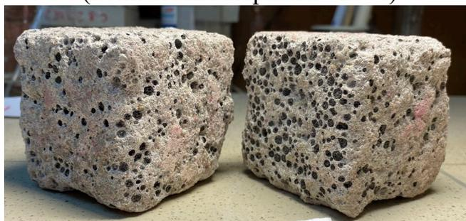
Рисунок 4.11 - Образцы после испытания на солестойкость
