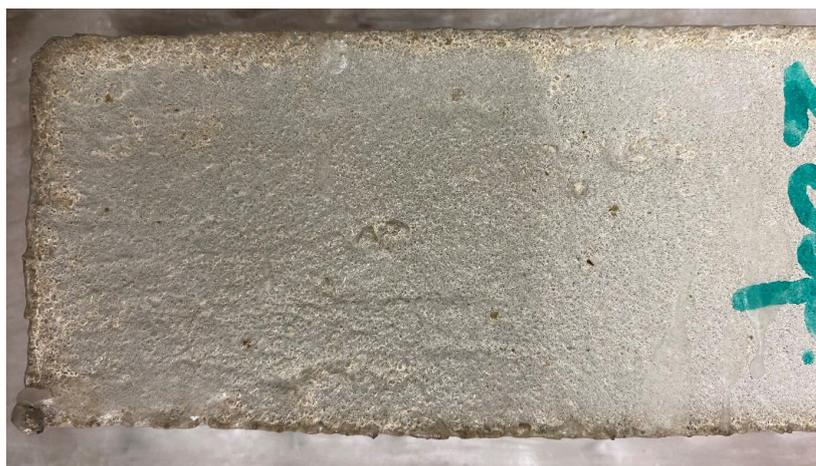
Рисунок 4.16 – «Вариант 2», на поверхности штукатурного покрытия отсутствуют высолы после насыщения в течение 14 сут в растворе NaCl 5%-ной концентрации
