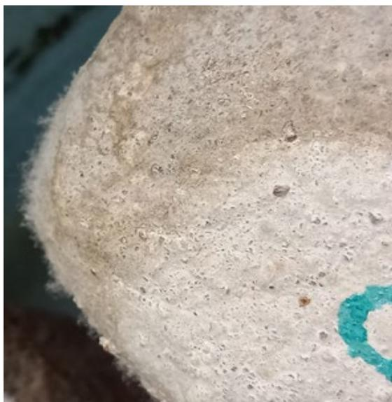
Рисунок 4.15 – «Контрольный» вариант, образование высолов на поверхности штукатурного покрытия после насыщения в течение 14 сут в растворе NaCl 5%-ной концентрации
