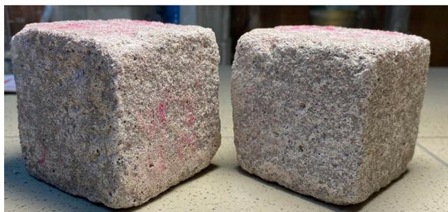
Рисунок 4.10 - Образцы после испытания на солестойкость
