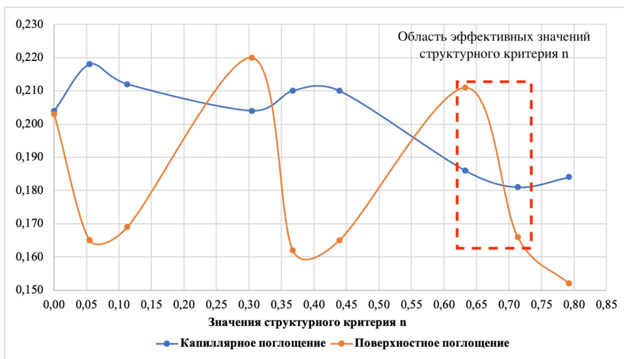
Рисунок 4.13 – Графическая зависимость между структурным критерием  $n$ , поверхностным и капиллярным поглощением
