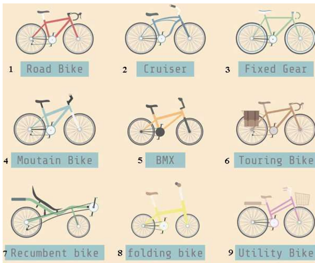
Рисунок 15 – Американская классификация велосипедов по типам. 1 класс – дорожный велосипед; 2 класс – городской велосипед (круизер); 3 класс – велосипед с
