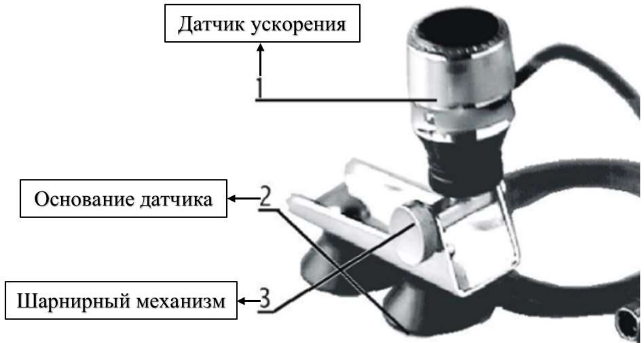
Рисунок 26– Датчик измерительного прибора
