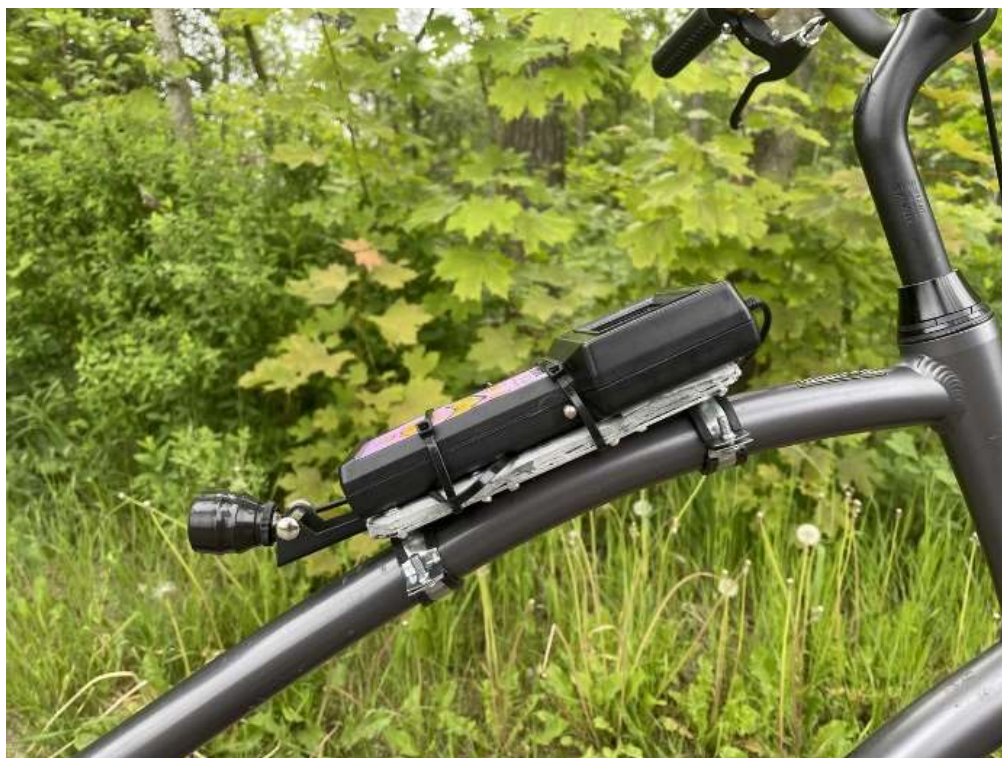
Рисунок 30 – Конструкция крепления деселерометра модели «LWS-2MC» (вид с боку)
