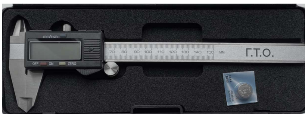
Рисунок 24 – Электронный штангенциркуль ГТО ШЦЦ-I-150
