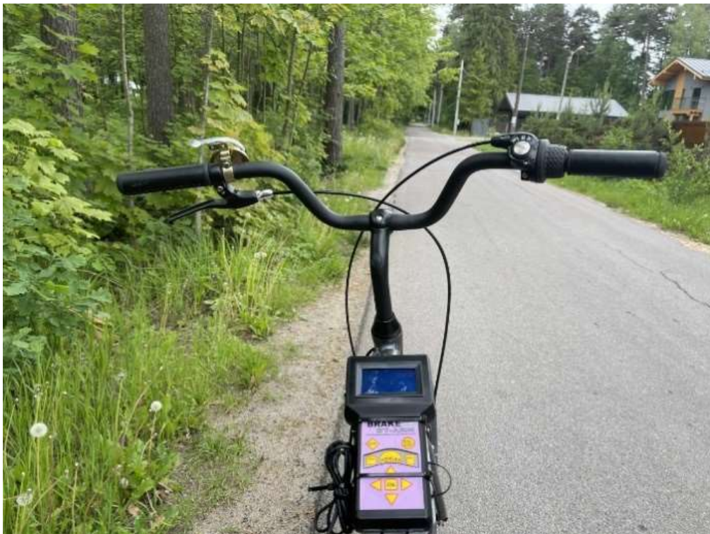
Рисунок 29 – Пример крепления измерительного прибора на НМТС при проведении экспериментальных исследований (вид со стороны велосипедиста)
