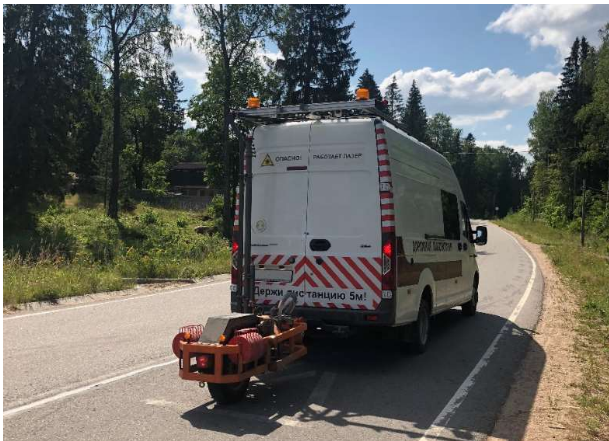
Рисунок 17– Дорожная лаборатория КП-514 РДТ с динамометрическим прицепом типа ПКРС-2 РДТ
