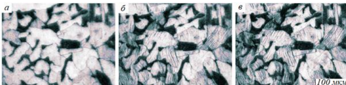
Рисунок 3.9 – Металлическая поверхность образца: а – до испытаний; б – после 10^3 циклов нагружения; в – после 2 \times 10^3 циклов. нагружения
