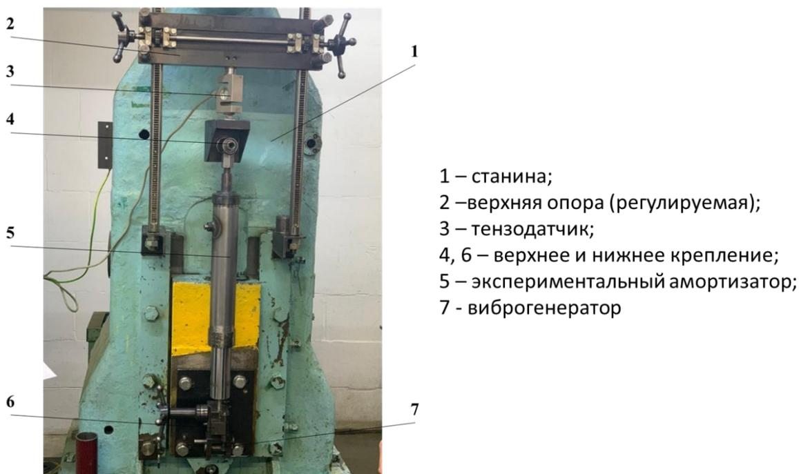
Рисунок 4.4 – Установка для проведения экспериментальных исследований:
