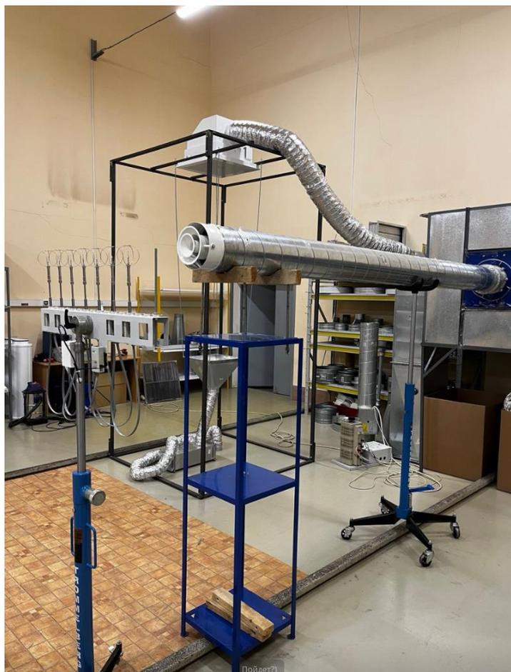
Рисунок 4.7 – Аэродинамические испытания диффузора SMK
