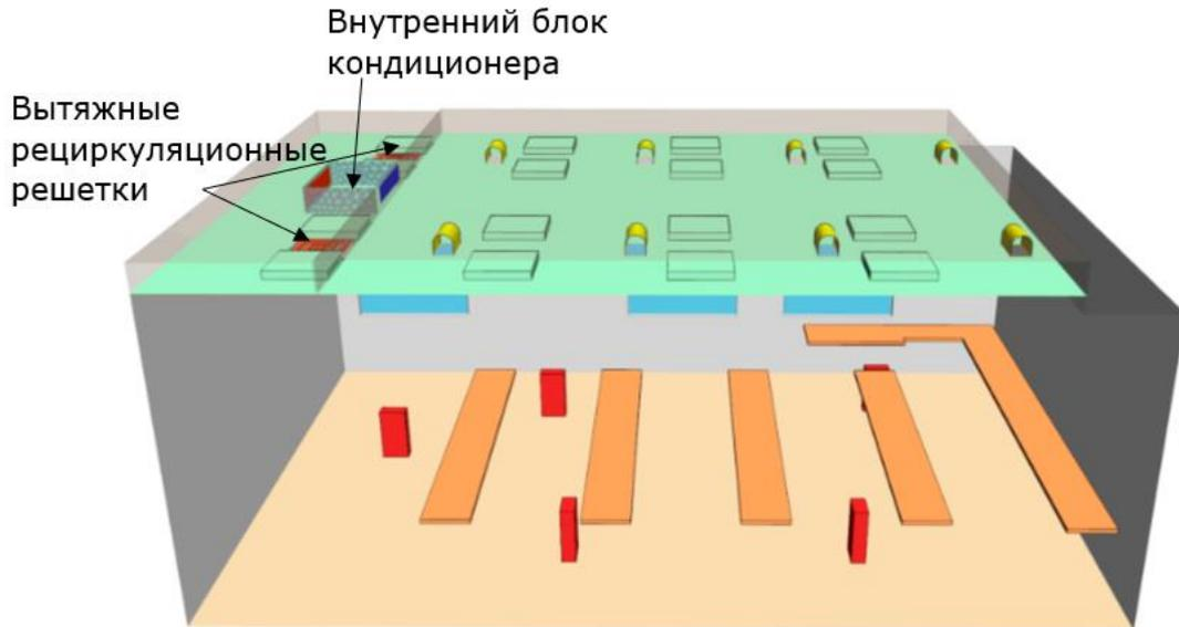
Рисунок 5.89 – Геометрия исследуемого помещения. Слева по центру потолочного пространства – внутренний блок системы кондиционирования. Слева и справа от него – вытяжные решетки 4АПН
