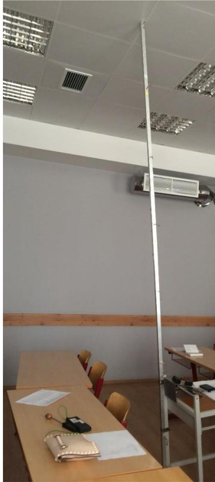
Рисунок 5.86 – Измерение температуры по высоте помещения с помощью термопар
