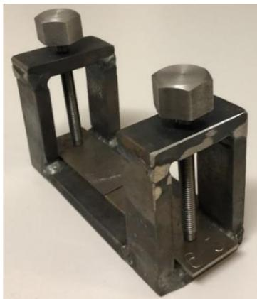
Рисунок 3.6 – Приспособление для фиксации свариваемых деталей
