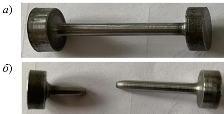
Рисунок 3.2 – Образец на растяжение до испытаний (а) и после (б)
