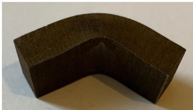
Рисунок 4.13 – Внешний вид образца после испытаний на изгиб
