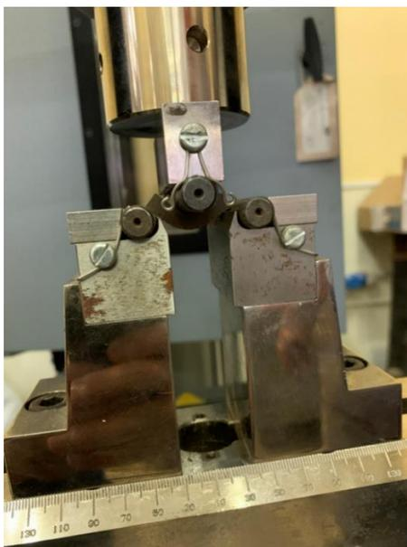
Рисунок 3.3 – Приспособление для испытаний на изгиб
