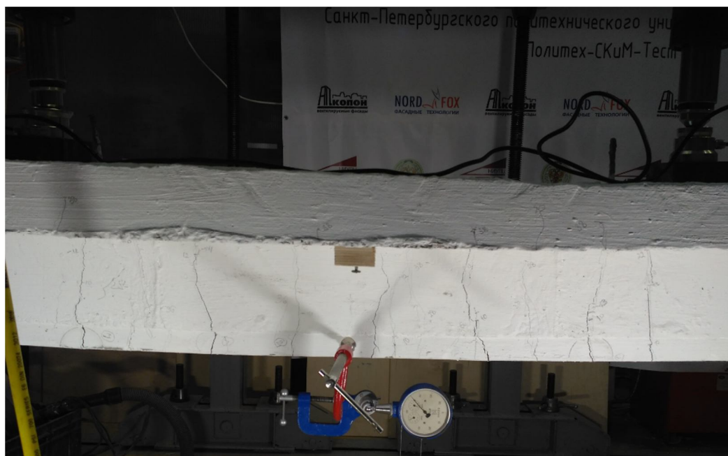
Рисунок 3.3 – Схема образования трещин по растянутой зоне элемента
