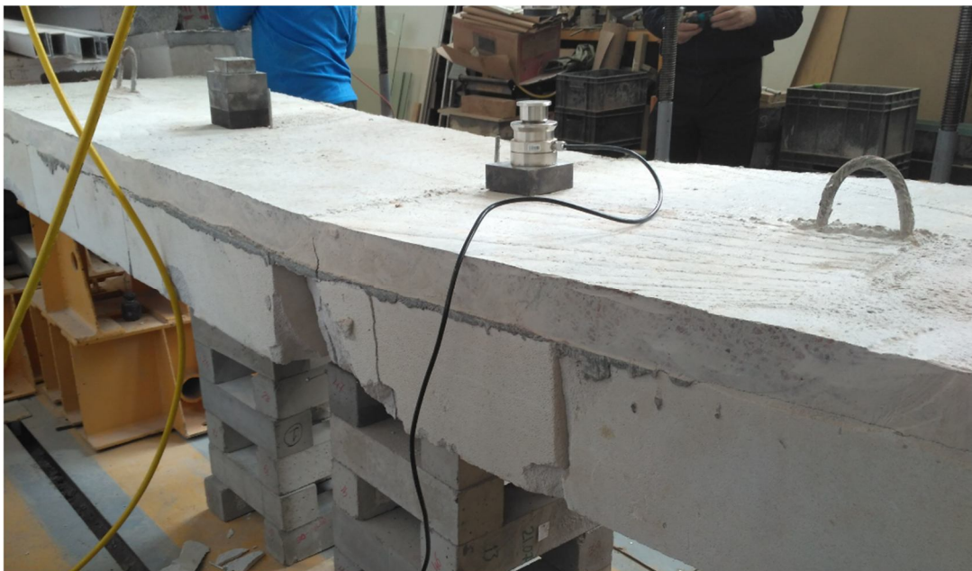
Рисунок 3.7 – Вид разрушения балки II
