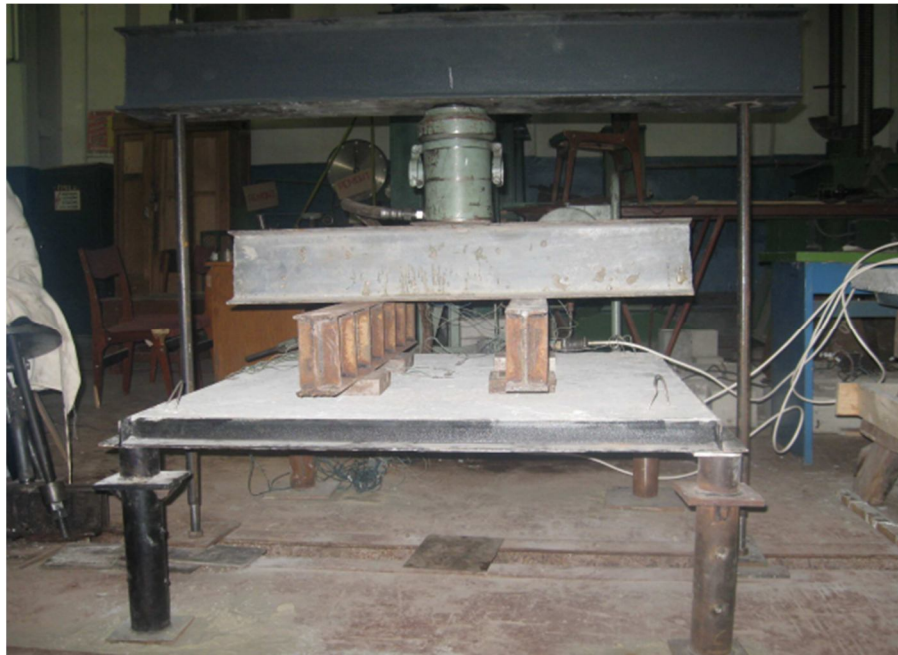
Рисунок 1.17 – Испытания безбалочного сталежелезобетонного перекрытия
