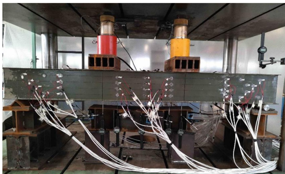
Рисунок 1.22 – Установка для испытания образцов коробчатых стальных перекрытий, заполненных бетоном
