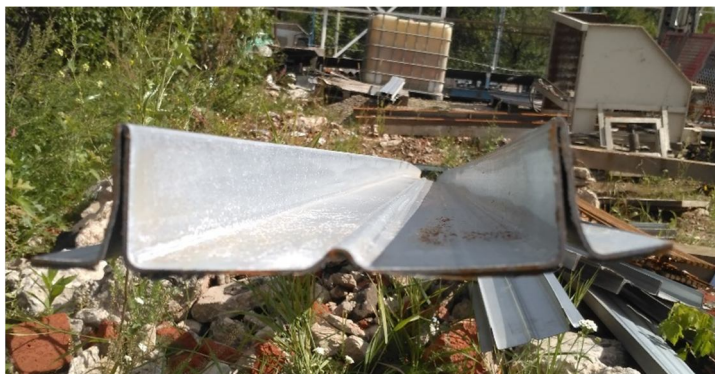
Рисунок 2.3 – Стальной профиль «Универсал» в условиях строительной площадки
