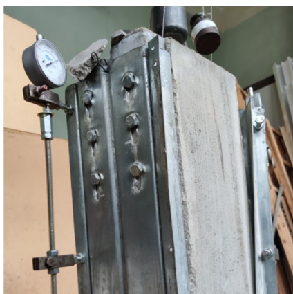
Рисунок 3.16 – Виды разрушения листов прокатного профиля с типами анкеровок 2 и 4
