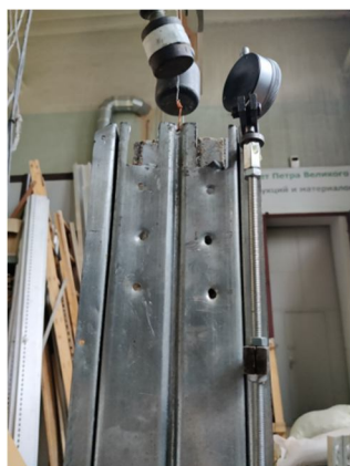
Рисунок 3.17 – Виды разрушения листов прокатного профиля с типом анкеровки 3
