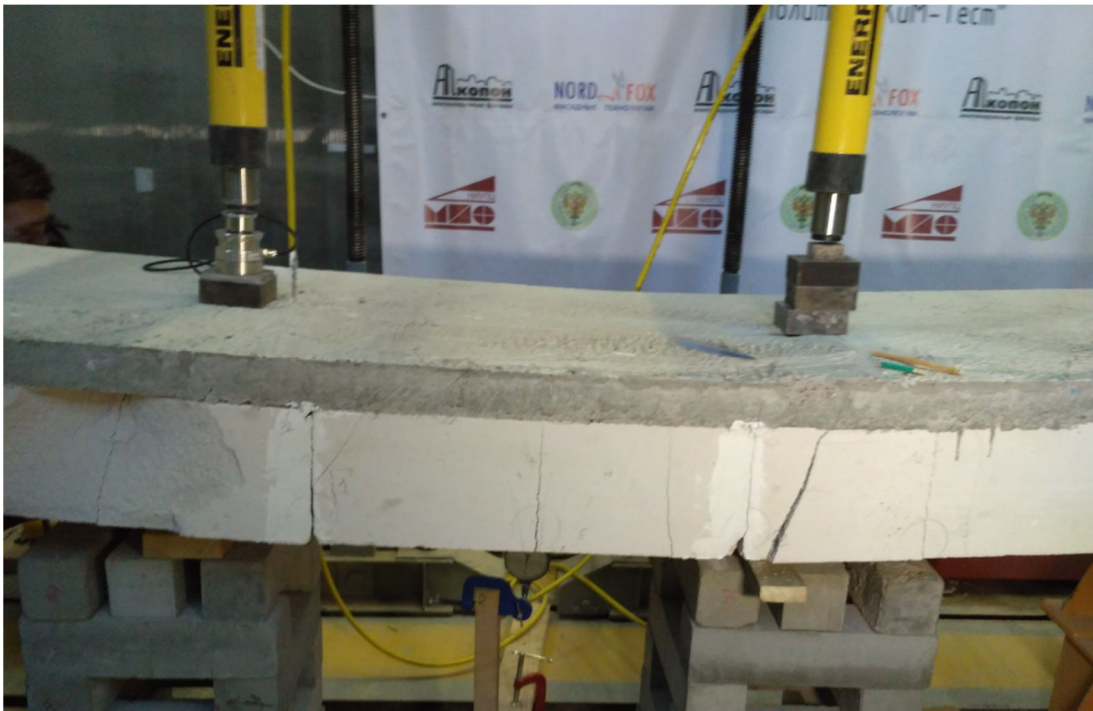
Рисунок 3.6 – Вид разрушения балки IV
