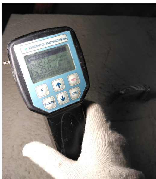
Рисунок 2.10 – Ультразвуковой измеритель прочности бетона УКС-МГ4С
