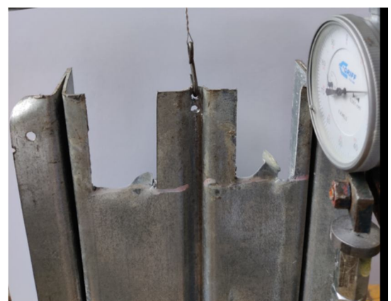
Рисунок 3.16 – Виды разрушения листов прокатного профиля с типами анкеровок 2 и 4
