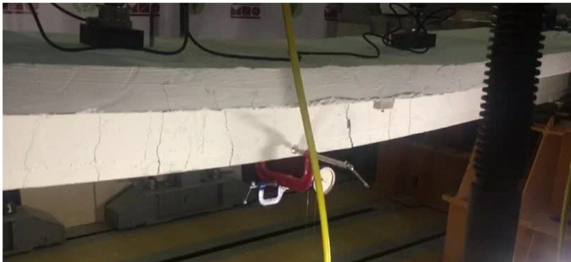
Рисунок 3.8 – Вид разрушения балки I-II
