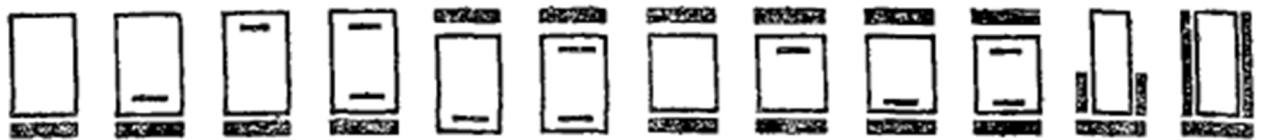
Рисунок 1.5 – Виды продольного армирования элементов с внешней арматурой
