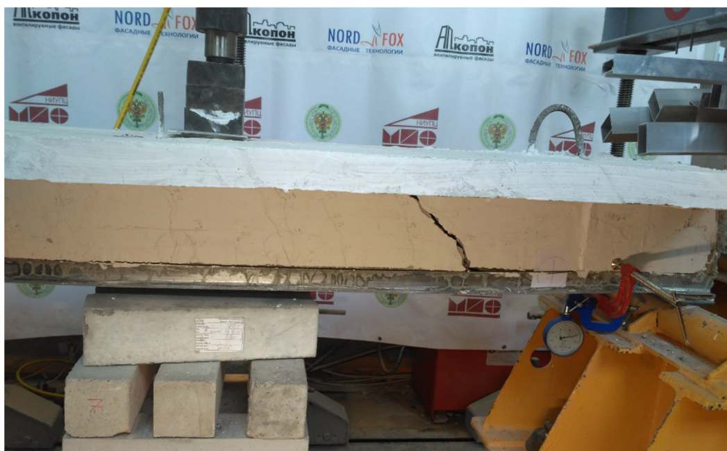
Рисунок 3.5 – Разрушение балки III-II
