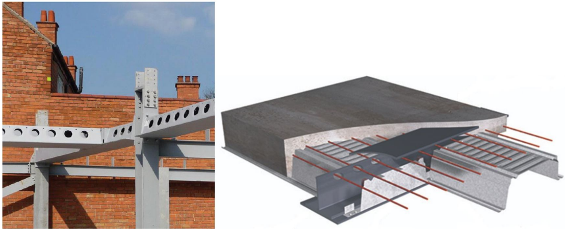
Рисунок 1.33 – Конструкция перекрытия «SlimFloor» [31]
