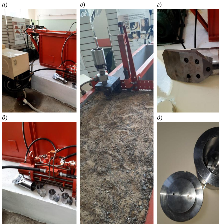
Рисунок 8. Фотоматериал проведенных экспериментальных исследований: а-в – испытательный стенд, г – технологический инструмент, д – ГВК
