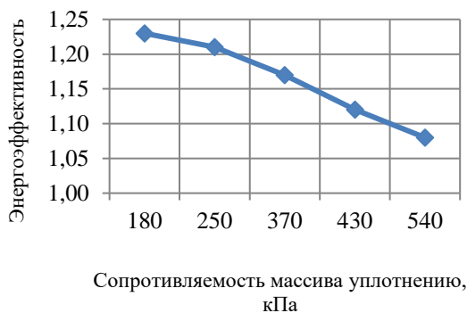
Рисунок 12. Влияние характеристики рабочей среды на энергоэффективность работы МГНБ
