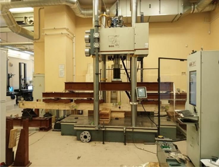
Рисунок 8 – LVL-балка перед испытанием
