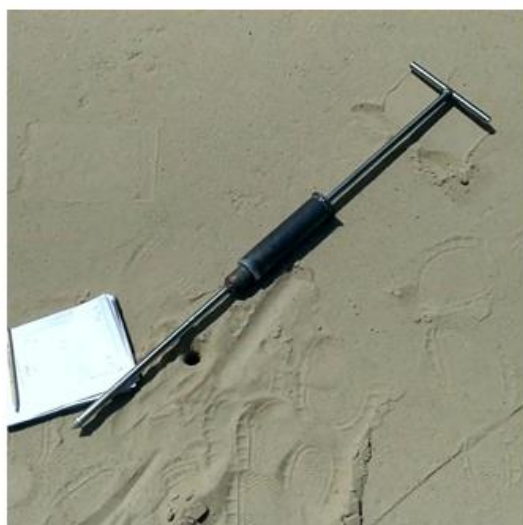
Рисунок 3.2 Измерительное оборудование: а - плотномер динамический Д-51; б - динамометр сжатия-растяжения «МЕГЕОН-04200»
