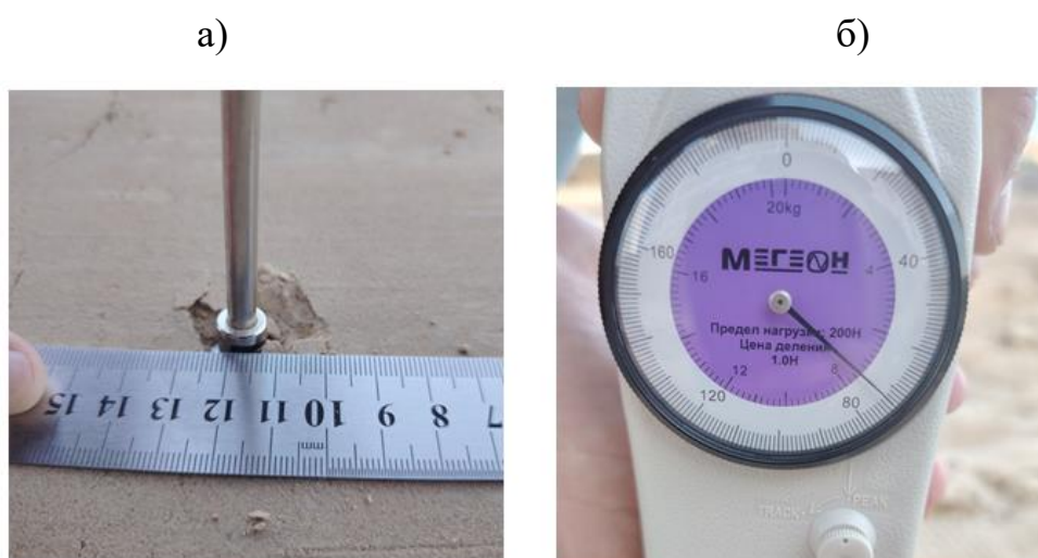
Рисунок 3.5: а) погружение динамометра до отметки, б) вывод показаний динамометра
