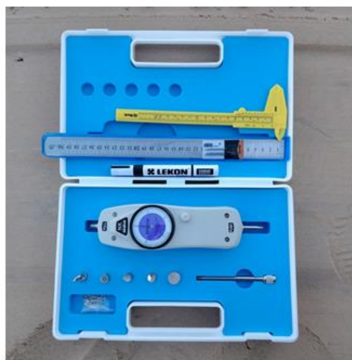
Рисунок 3.2 Измерительное оборудование: а - плотномер динамический Д-51; б - динамометр сжатия-растяжения «МЕГЕОН-04200»
