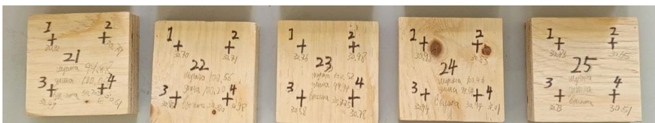
Рисунок 4.3 – Образцы из LVL для определения плотности
