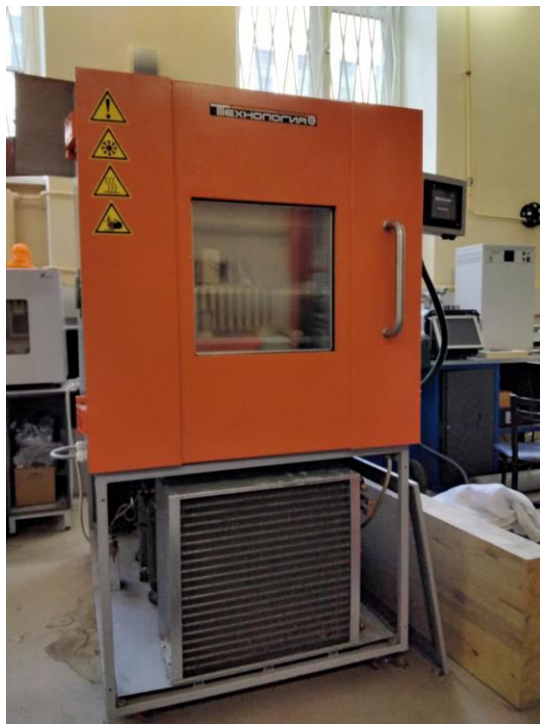
Рисунок 4.1 – а) Общий вид испытательной камеры «Тепло – Холод – Влага» серии КТХВ-300; б) образцы, помещенные для высушивания при определении влажности
