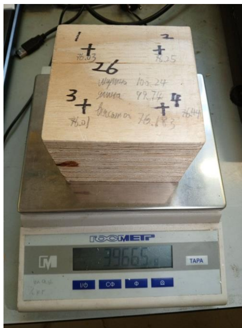
Рисунок 4.2 – Измерение массы образца на весах высокого (II) класса точности при определении их влажности
