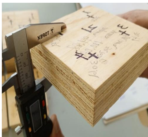
Рисунок 4.4 – Измерение толщины образца для определения плотности:
