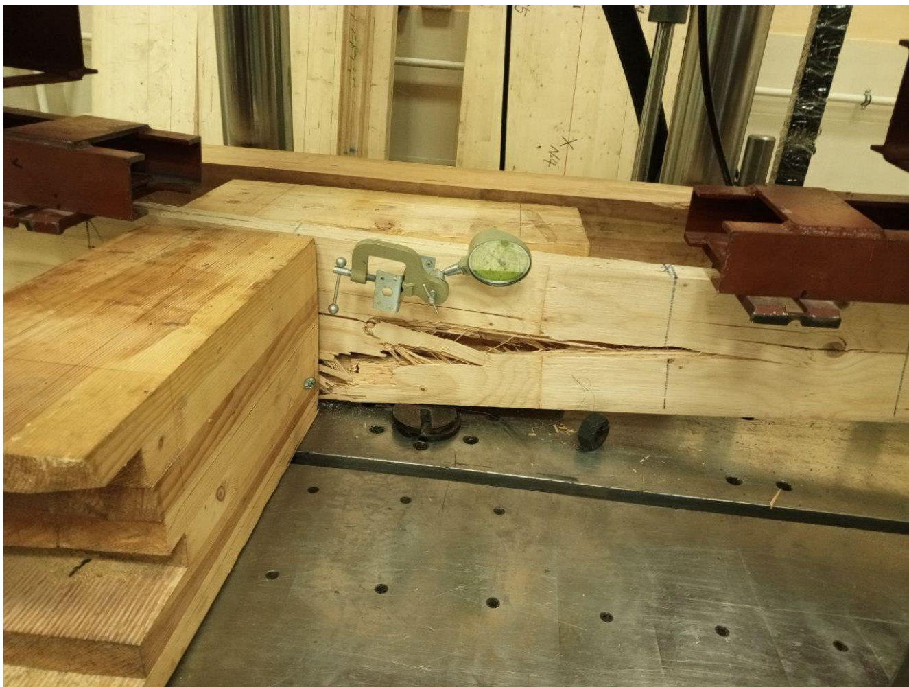
Рисунок 5.3 – Образец LVL-балки № 2 после разрушения при испытаниях со скоростью нагружения 10 мм/мин
