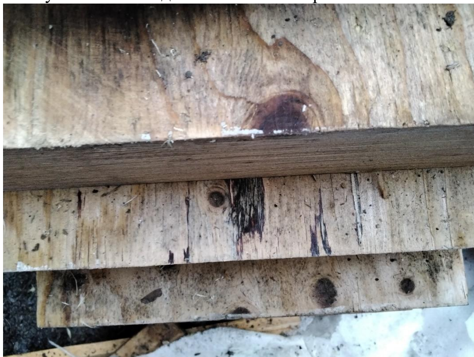
Рисунок 5.7 – Биопоражения участков грибом
