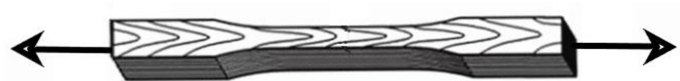
Рисунок 3.3 – Схема кратковременных испытаний образцов LVL при растяжении с нагрузкой, изменяющейся во времени по линейному закону
