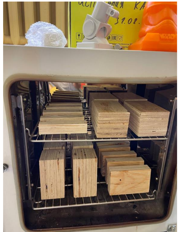
Рисунок 4.1 – а) Общий вид испытательной камеры «Тепло – Холод – Влага» серии КТХВ-300; б) образцы, помещенные для высушивания при определении влажности
