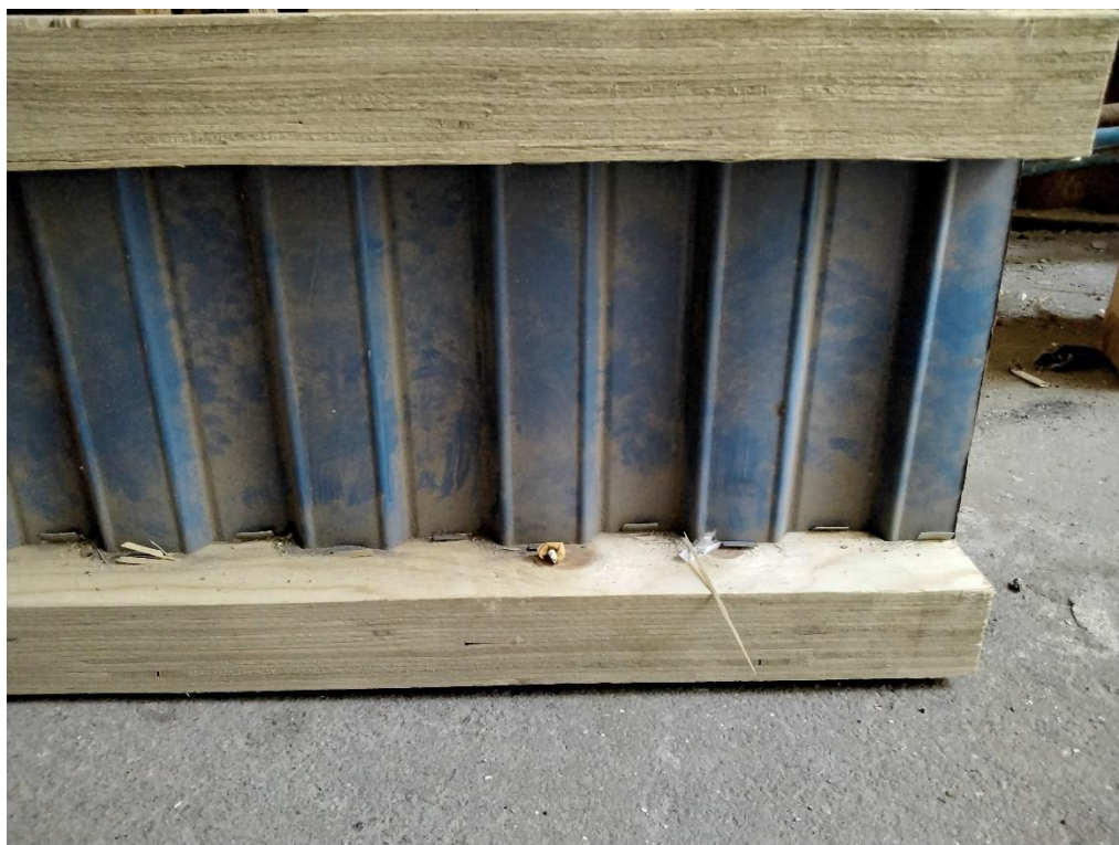
Рисунок 1.7 – Балка двутавровая деревянно-металлическая с поясами из LVL
