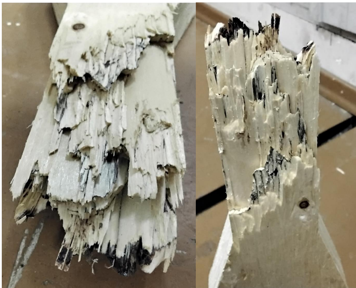
Рисунок 4.8 – Характерные разрушения образца при растяжении вдоль волокон (размер 30x50 мм) со скоростью нагружения 4 мм/мин
