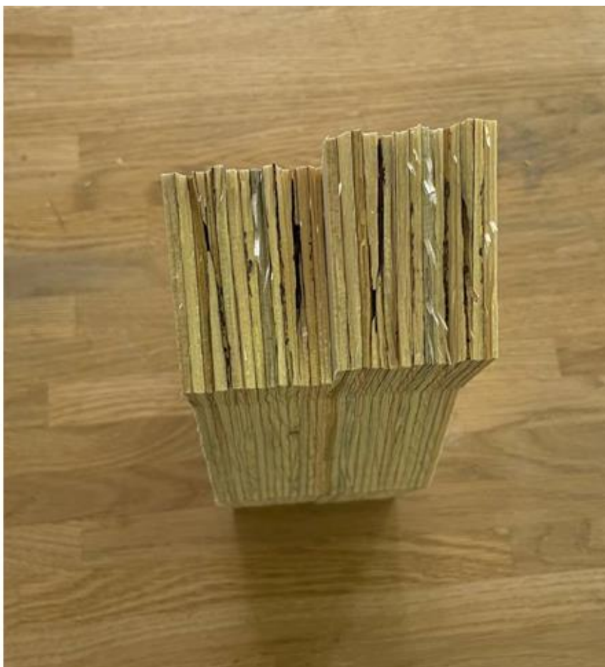
Рисунок 4.12 – Вид сечения и характер разрушения образца при растяжении
