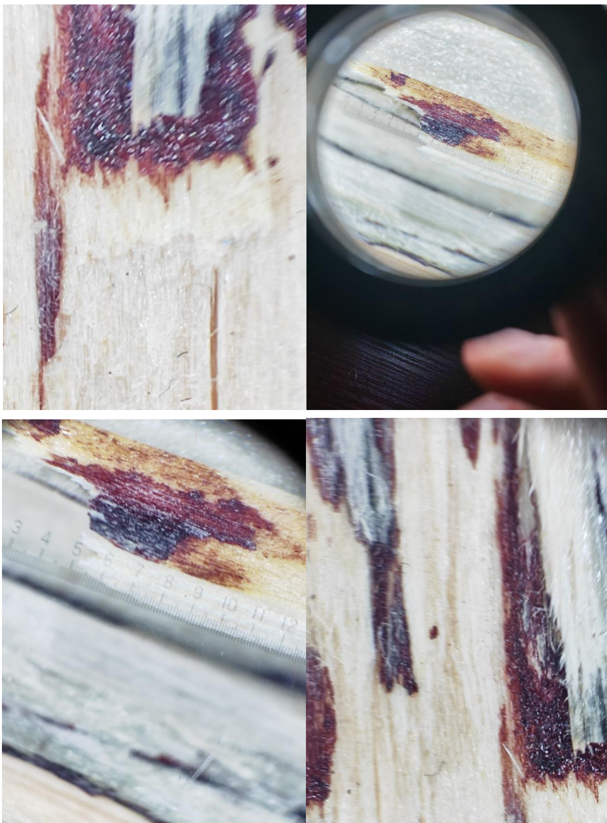
Рисунок 4.9 – Участки разрушения образцов при растяжении вдоль волокон (размер 30x50 мм) со скоростью нагружения 4 мм/мин
