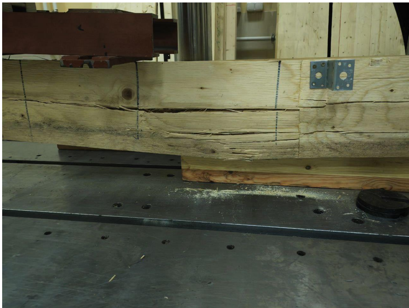
Рисунок 5.2 – Образец LVL-балки № 1 после разрушения при испытаниях со скоростью нагружения 10 мм/мин
