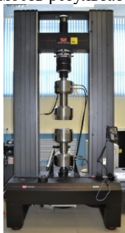
Рисунок 13 – Испытательное оборудование Instron-5989
