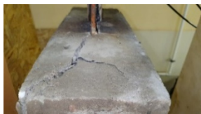
Рисунок 14 – Характер восприятия нагрузки опытными образцами
