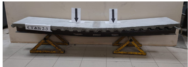
Рисунок 3.16 – Характер разрушения образцов серии СТЖБ-1 а) и серии СТЖБ-2 б)
