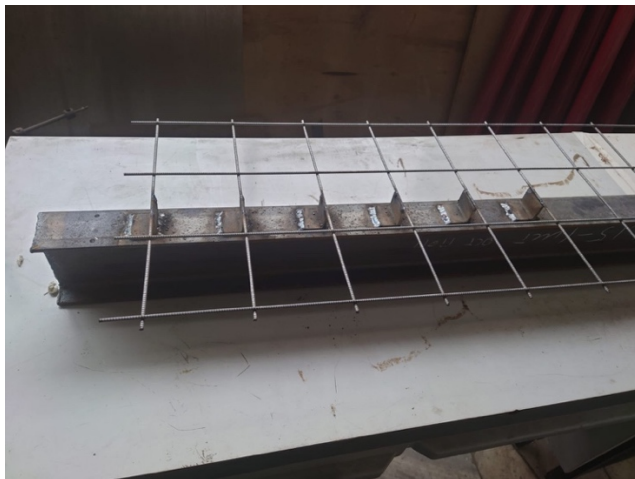
Рисунок 3.5 – Общий вид двутавров для серии СТЖБ-1 с приваренными уголками а) и для серии СТЖБ-2 с профилированным настилом б)
