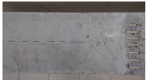
Рисунок 3.14 – Характер развития трещин в образцах серии СТЖБ-1
