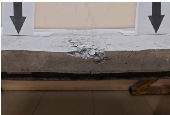
Рисунок 3.15 – Раздробление бетона сжатой зоны в образцах серии СТЖБ-1 в середине пролета а) и под силой б)
