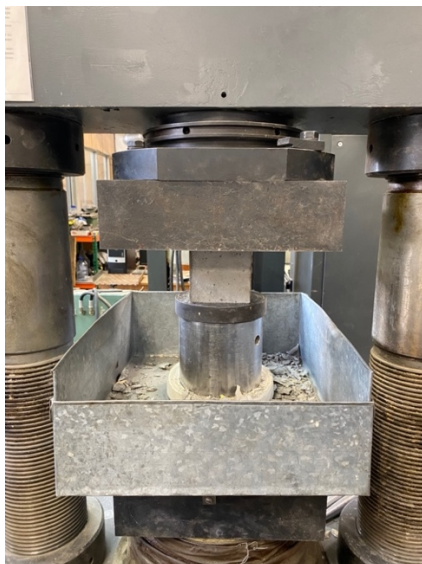
Рисунок 3.8 – Испытание бетонных кубов а) и призм б)
