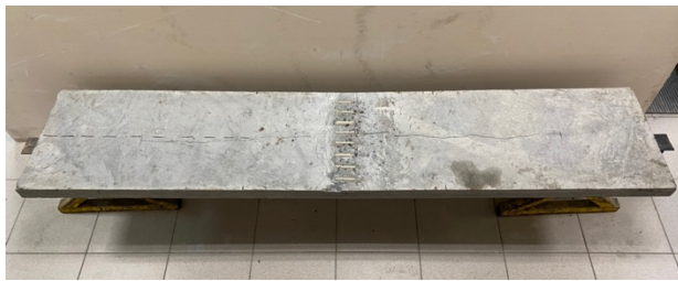
Рисунок 3.14 – Характер развития трещин в образцах серии СТЖБ-1
