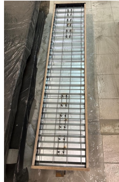
Рисунок 3.6 – Общий вид образцов в опалубке
