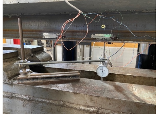
Рисунок 3.10 – Индикаторы часового типа для измерения сдвигов а) и прогибов б)
