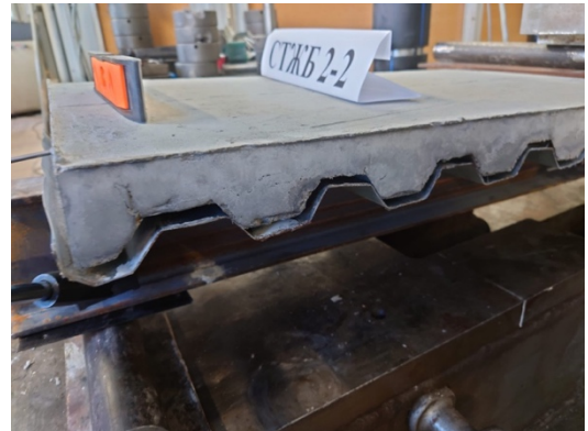
Рисунок 3.21 – Отслоение бетона от профилированного настила на одном торце балки
