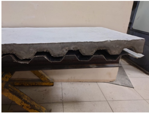
Рисунок 3.21 – Отслоение бетона от профилированного настила на одном торце балки
