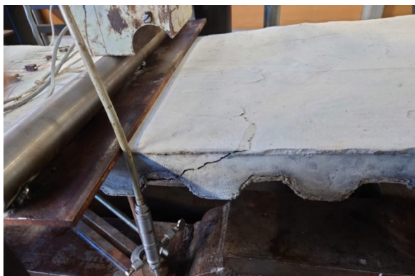
Рисунок 3.22 – Раскалывание бетона в сжатой зоне в образцах серии СТЖБ-2 в стороне от места приложения силы
