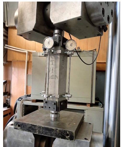
Рисунок 3.8 – Испытание бетонных кубов а) и призм б)
