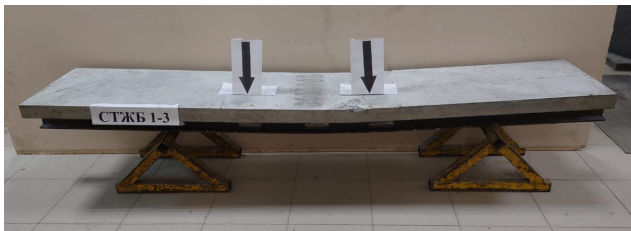
Рисунок 3.16 – Характер разрушения образцов серии СТЖБ-1 а) и серии СТЖБ-2 б)
