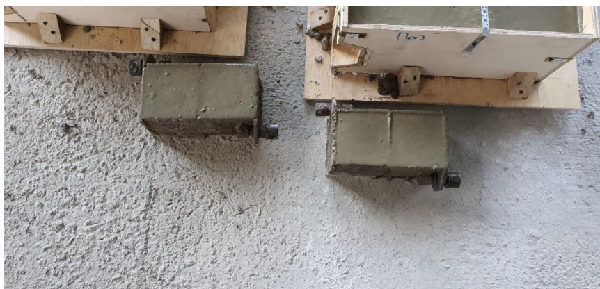
Рисунок 3.13 – Сформированные образцы для проверки прочностных характеристик бетона разрушающим методом.
