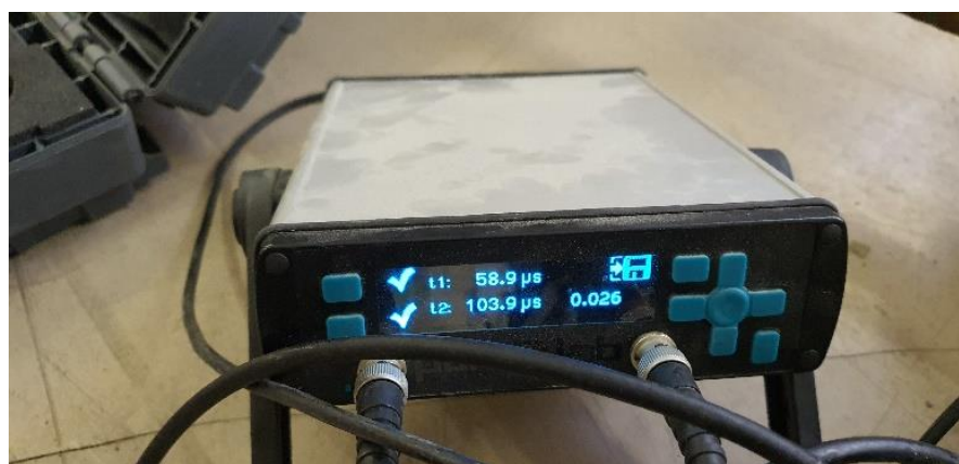
Рисунок 3.24 – Замеры трещин ультразвуковым прибором.
