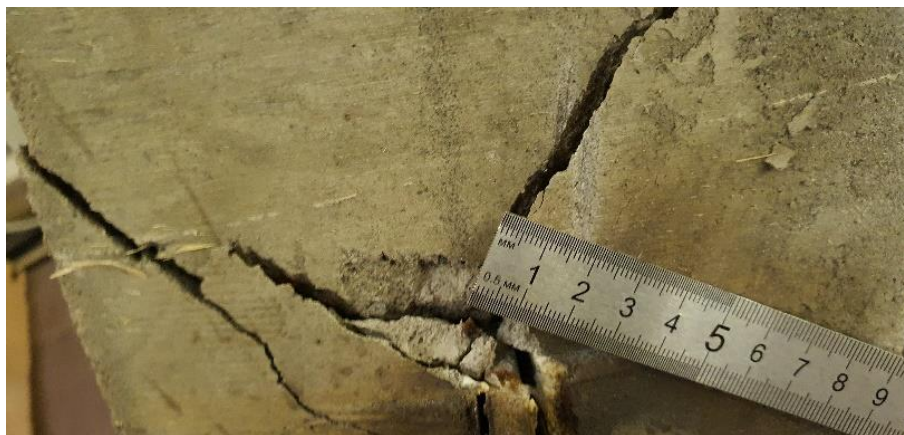
Рисунок 3.23 – Наиболее характерные повреждения контрольных образцов.
