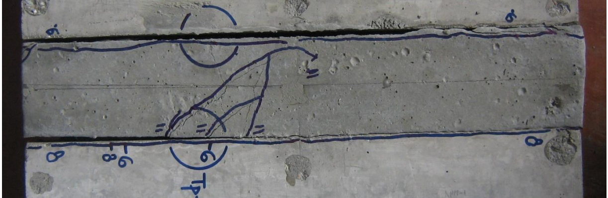
Рисунок 2.8 – Вид характерной схемы разрушения образцов линейного стыка при растяжении
