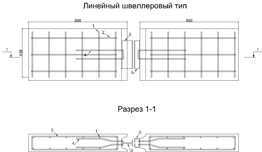
Рисунок 3.6 – Схема линейного швеллерового узлового соединения.
