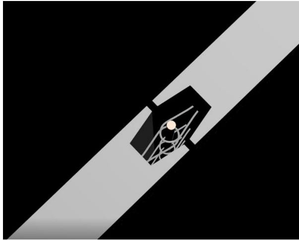
Рисунок 1.15 – Нахлест петель и арматурный стержень
