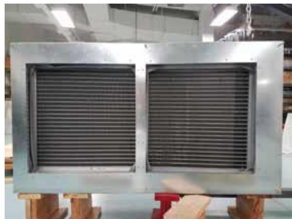
Рисунок 1.12 – Приточно-вытяжная вентиляционная установка с тепловыми трубами а) схема [91]; б) вид теплообменника с тепловыми трубами [97, 105]; 1 – вход наружного воздуха; 2 – воздушный фильтр; 3 – теплообменник с горизонтальными тепловыми трубами; 4 – воздухонагреватель (воздухоохладитель); 5 – приточный вентилятор; 6 – приточный воздух; 7 – вход воздуха, удаляемого из помещения; 8 – вытяжной вентилятор; 9 – удаляемый воздух
