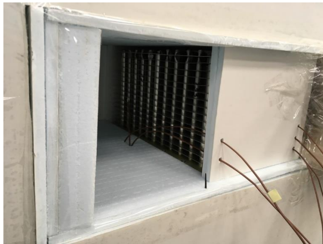
Рисунок 3.4 – Схема подключения оборудования при проведении эксперимента для определения показателей эффективности теплообмена [19]
