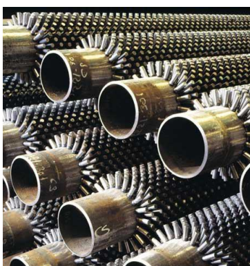
Рисунок 2.7 – Ошипованные трубы теплообменного аппарата
