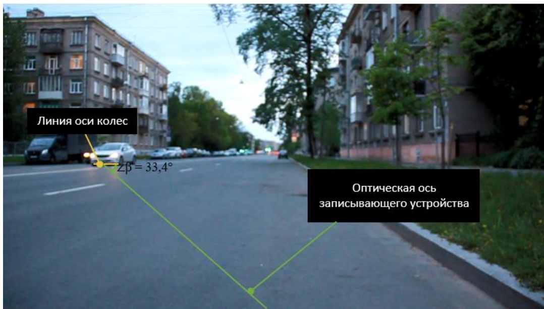
Рисунок 3.13 – Определение угла \beta (угол между осью колес и оптической осью видеозаписывающего устройства) при проведении экспериментальных исследований
