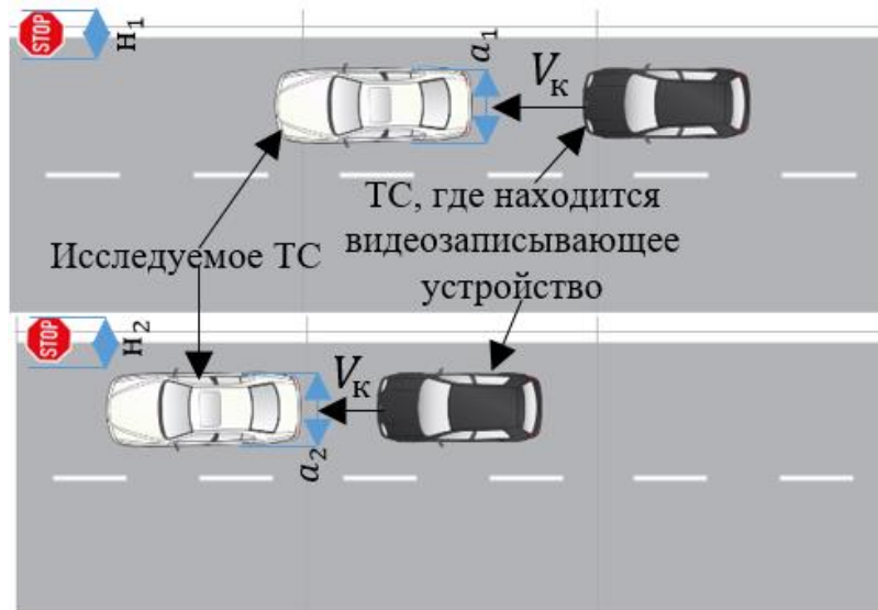
Рисунок 1.15 – Принципиальная схема рассматриваемого метода в случае съемки исследуемого ТС видеорегистратором, установленным в ТС, следующим за исследуемым ТС
