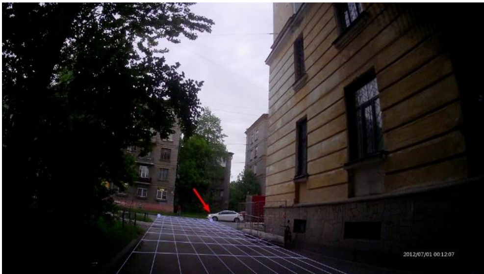
Рисунок 3.2 – Пример наложения «перспективной сетки», отображающей границы участка известной длины на дорожном полотне, с моментом фиксации исследуемого ТС у правого края данного участка (отмечено стрелкой красного цвета)
