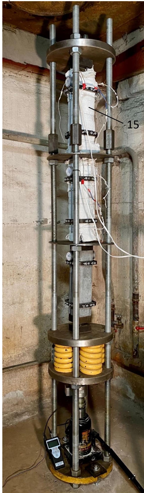
Рисунок 2.5 – Схема (а) и общий вид (б) установки для исследования ползучести бетона при осевом сжатии [29]
