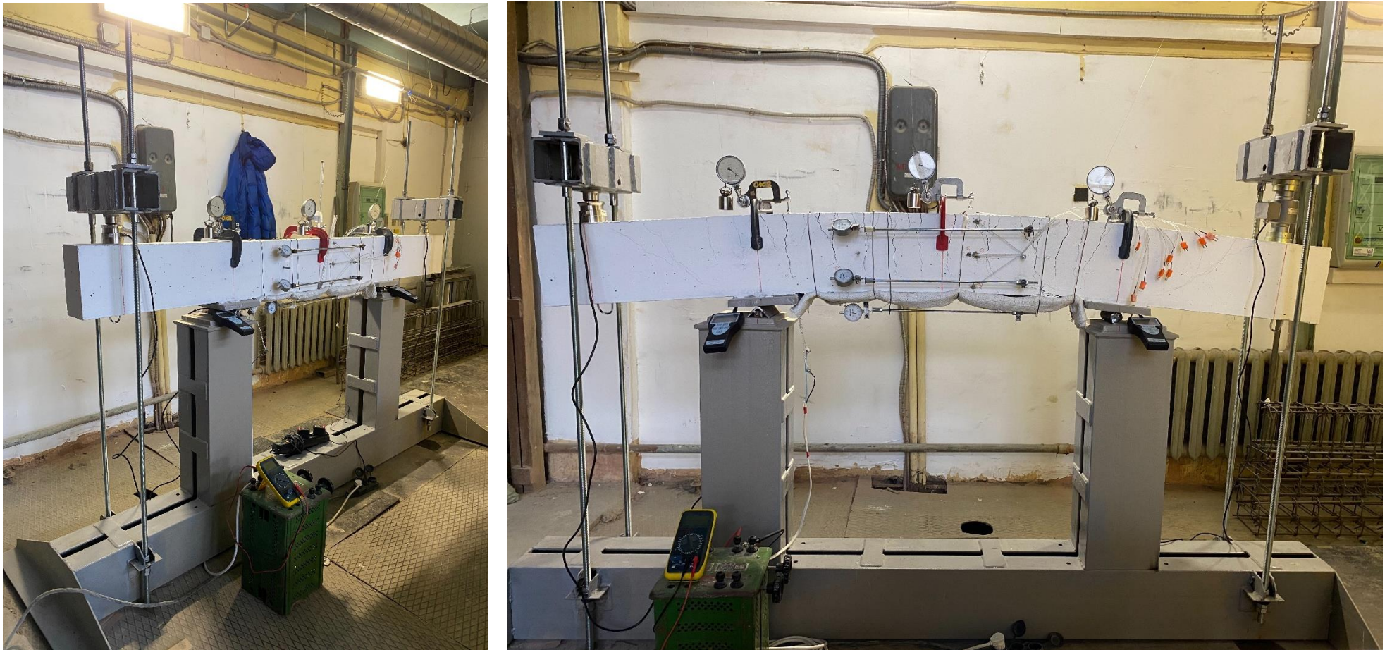
Рисунок 2.6 – Схема (а) и иллюстрация (б) установки для испытаний балок при неравномерном нагреве и последующем догрузении: 1 – опорная конструкция; 2 – тяги; 3 – траверса; 4 – динамометры сжатия; 5 – кварцевые удлинители; 6 – индикаторы часового типа; 7 – термопары; 8 – нагревательные элементы; 9 – прогибометры
