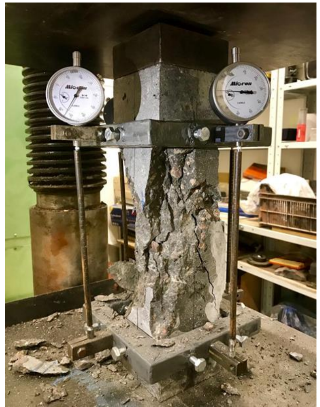
Рисунок 2.3 – Общий вид образцов-призм до (а) и после испытаний на осевое сжатие (б)
