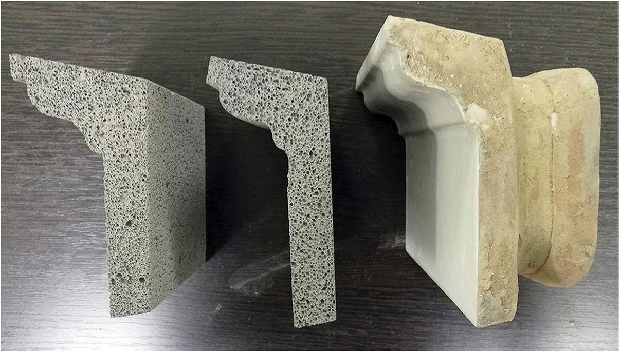
Рисунок 5.2 – Фотография промышленных образцов АКИ. Керамические фасонные изделия индивидуальных форм и размеров
