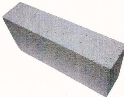
Фото №2. Кирпич азрированный керамический после обжига, 249x113x56 мм.
