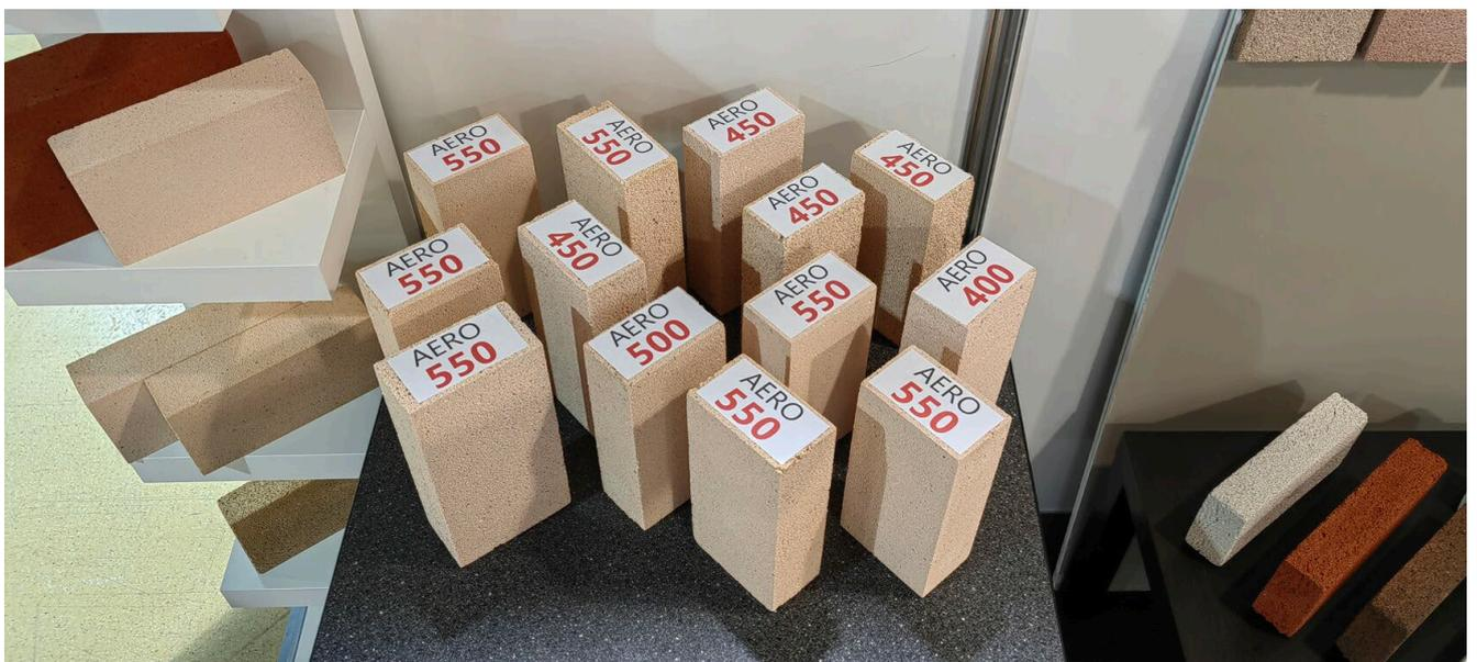
Рисунок 5.3 – АКИ различной средней плотности на основе каолиновой глины
