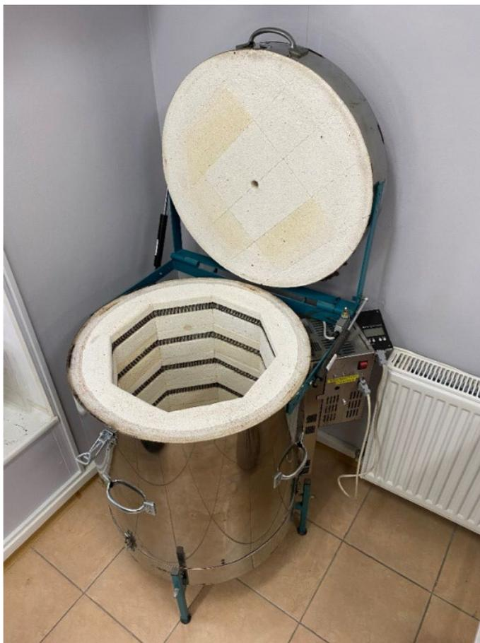
Рисунок 2.5 – Фотография лабораторной электрической печи «АГНИ Мастер 75»
