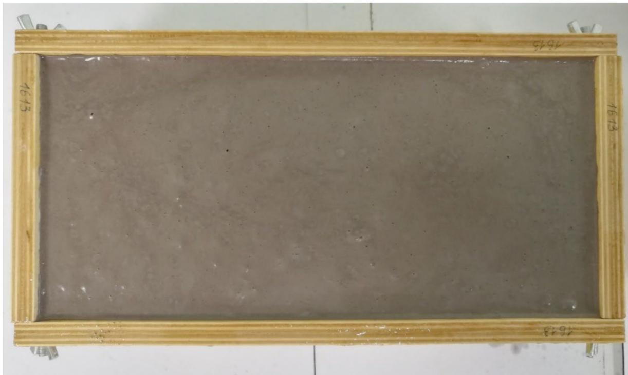
Рисунок 2.2 – Фотография АКМ на основе каолиновой глины после формования керамического сырья с применением воздухововлекающей добавки
