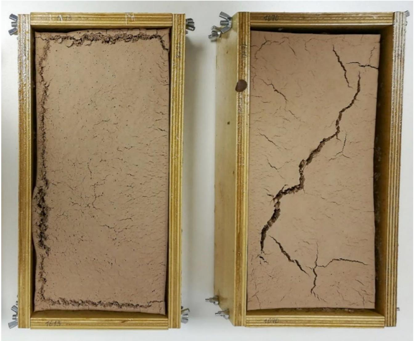
Рисунок 1.8 – Фотография поризованных (аэрированных) керамических сырцов, имеющих нарушения структурной сплошности (при их сушке)
