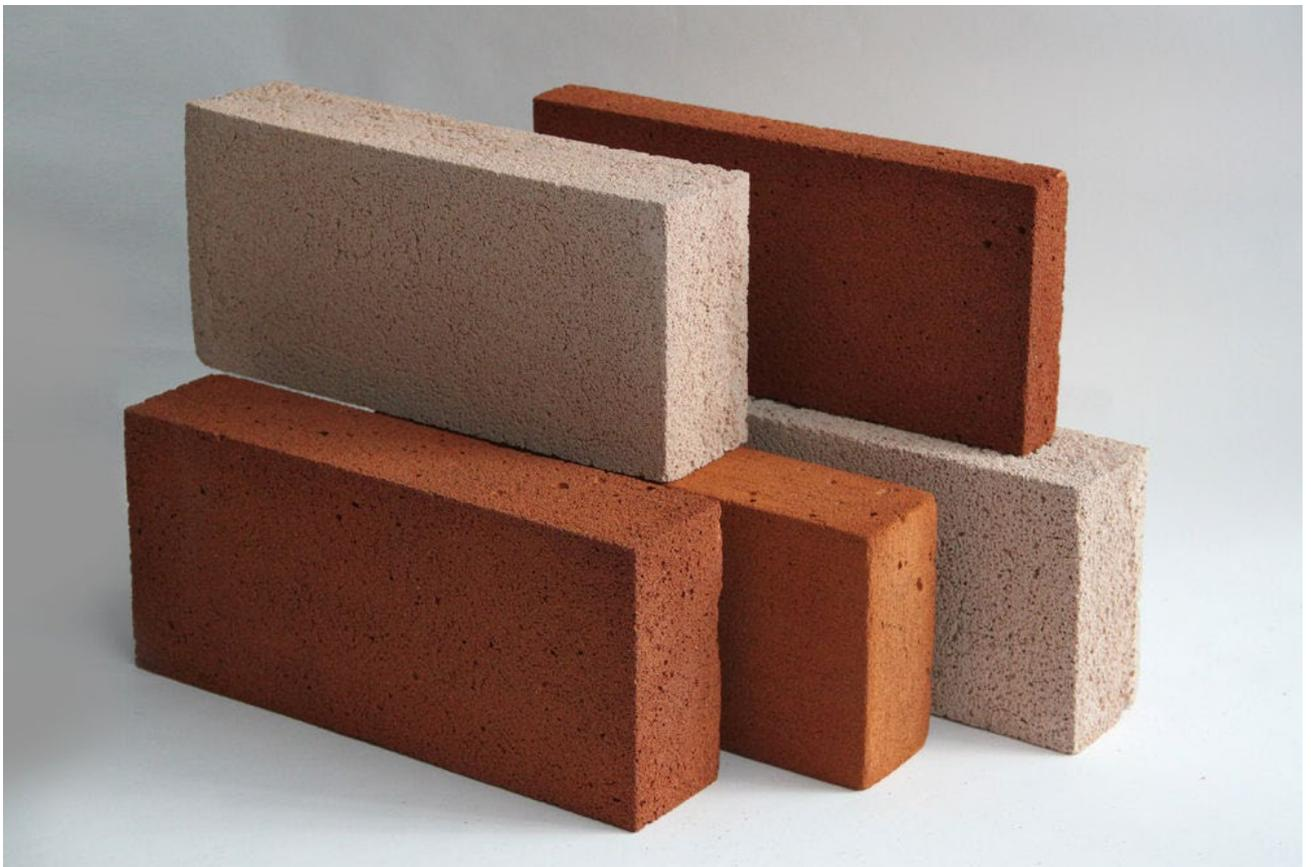
Рисунок 2.4 – Фотография АКИ на основе исследуемых глин в формате плитки и сплошных кирпичей
