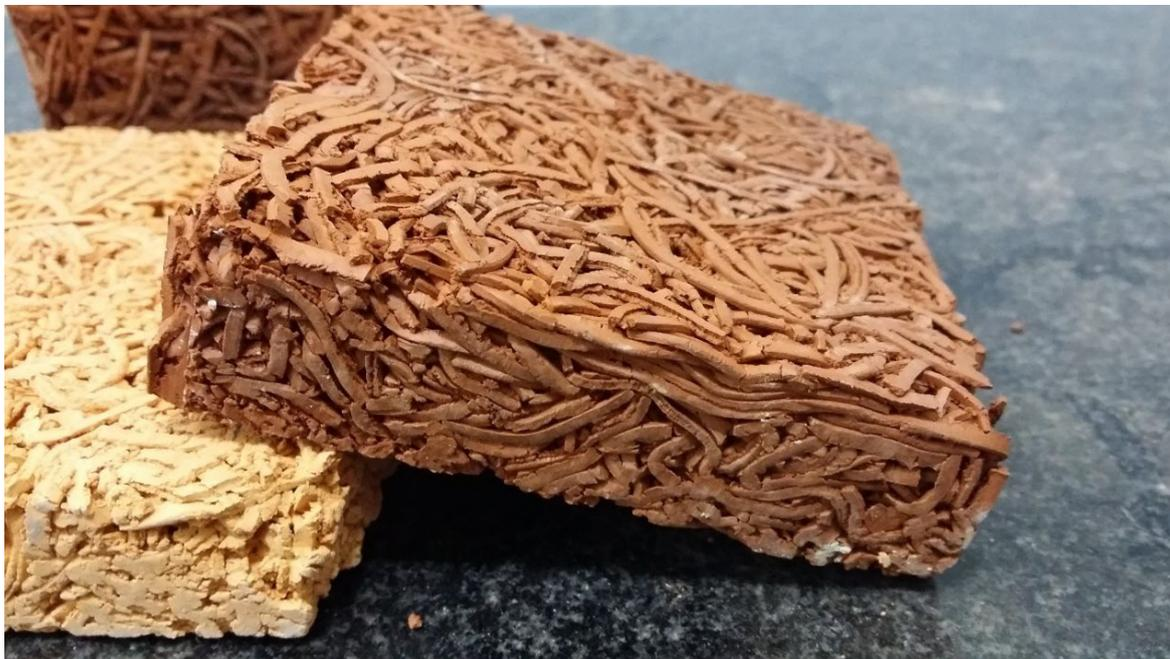
Рисунок 1.1 – Керамические изделия, изготовленные методом «неплотной упаковки»
