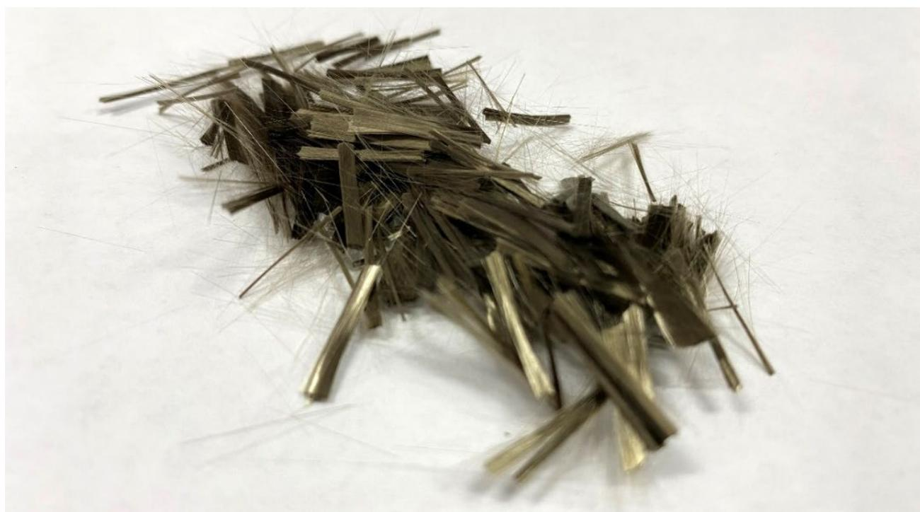
Рисунок 2.1 – Фотография армирующей добавки (базальтовая фибра)
