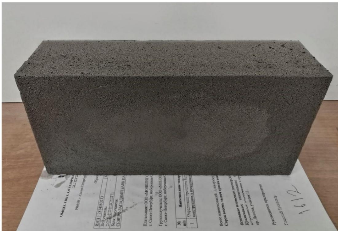
Рисунок 2.3 – Фотография АКС на основе каолиновой глины после распалубки
