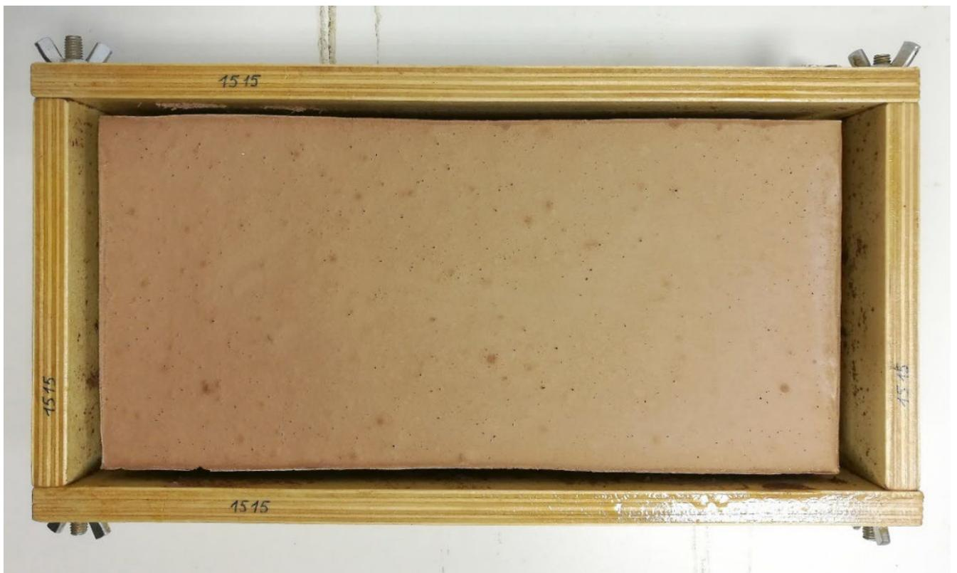
Рисунок 1.9 – Фотография аэрированного керамического сырца после сушки — отсутствие дефектов формы и поверхностей
