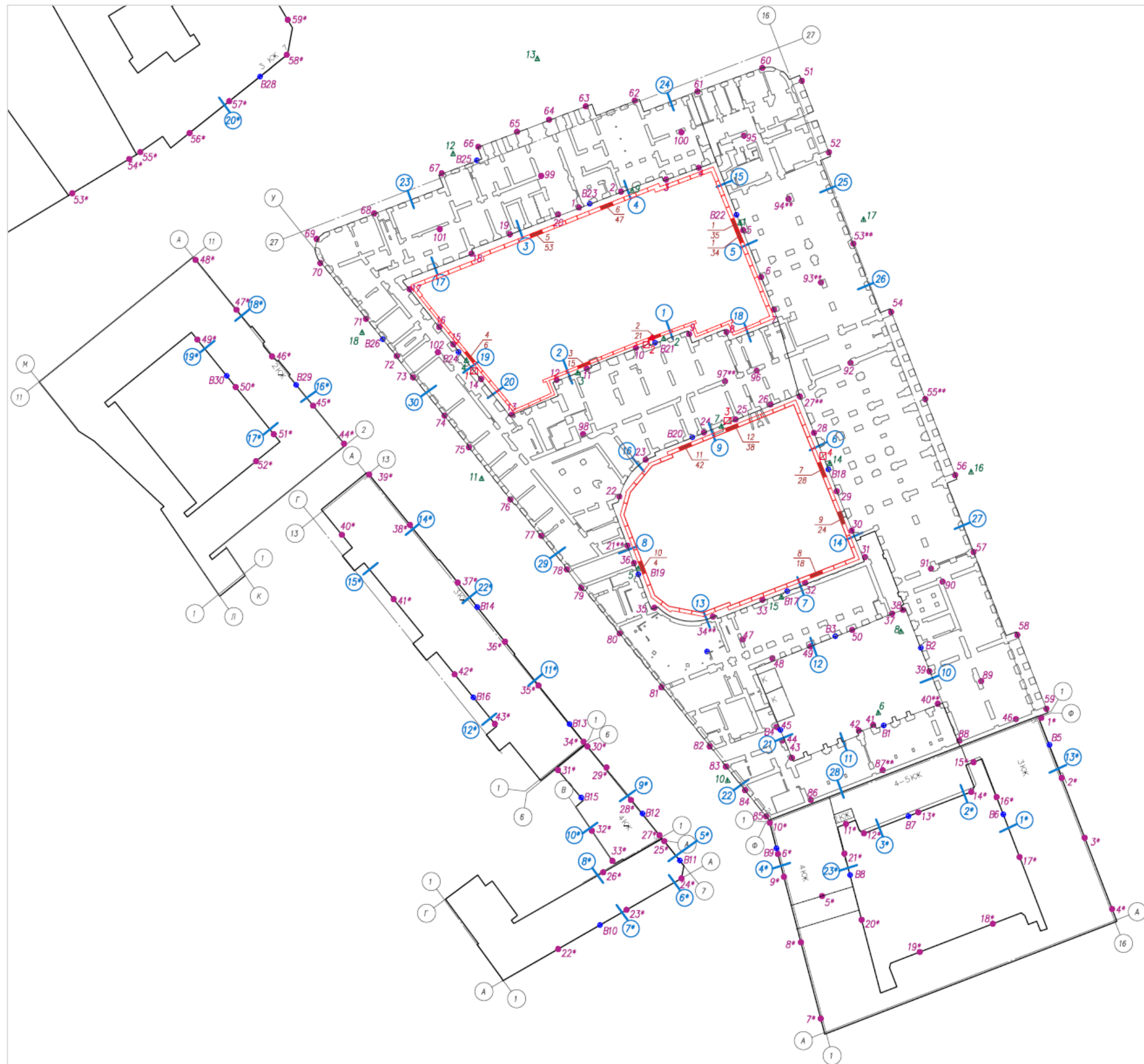
Рисунок 2.9. Схема организации контрольно-измерительного оборудования в границах реконструируемого здания.
