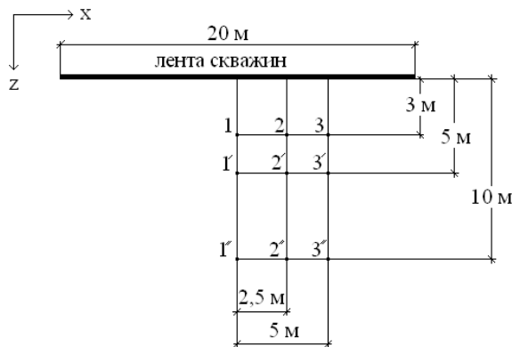
Рисунок 3.11. Схема расположения точек для анализа горизонтальных перемещений при устройстве скважин, выполняемых в составе ленты.
