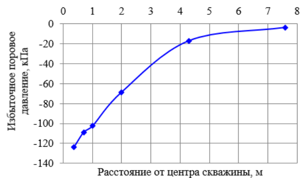
Рисунок 3.3. Избыточные поровые давления через 1 сутки после нагружения на расстояниях от центра одиночной скважины при объёмной боковой деформации \varepsilon_v , равной 1,5%
