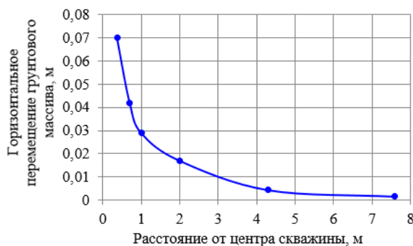
Рисунок 3.2. Горизонтальные перемещения при устройстве одиночной восьмигранной скважины при объёмной боковой деформации \varepsilon_v , равной 1,5%
