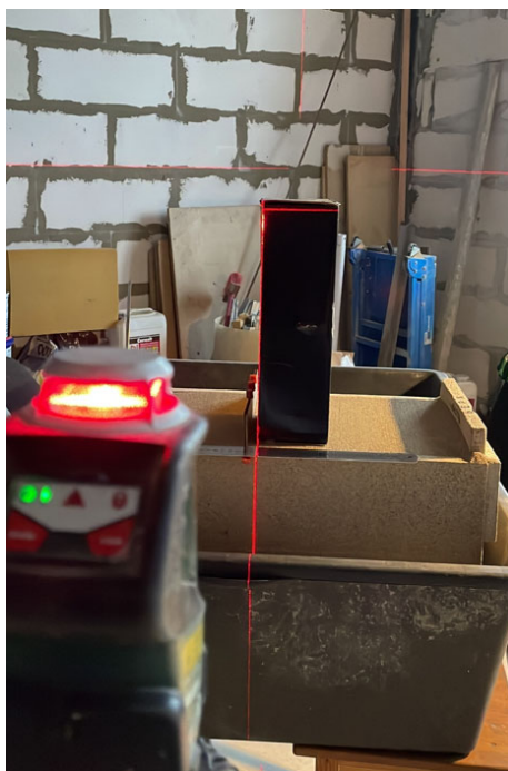
Рисунок 2.2. Обеспечение вертикального положения моделей здания и ограждения до начала эксперимента.
