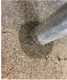
Рисунок 7 – Внешний вид талика, полученного на экспериментальной установке
