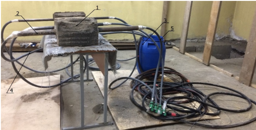
Рисунок 6 – Лабораторная экспериментальная установка: 1 – блок мёрзлого грунта из песка; 2 – трубопровод; 3 – бак с погружным насосом; 4 – подающий шланг; 5 – отводящий шланг
