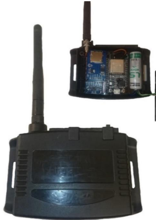
Рисунок 2.18 – Опытный образец (прототип) устройства мониторинга положений канатов и груза грузоподъемного крана в корпусе
