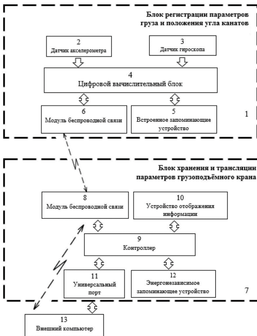
Рисунок 2.10 – Структурная схема устройства мониторинга положений канатов и груза грузоподъемного крана (патент RU 196670)
