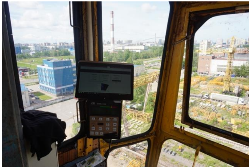
Рисунок 2.24 – Крепление планшетного компьютера в кабине башенного крана КБ 503Б №553
