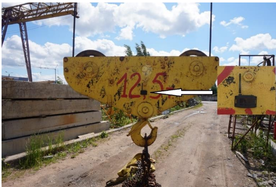
Рисунок 2.23 – Крюковая подвеска с устройством мониторинга положений канатов и груза грузоподъемного крана на башенном кране КБ 674 №760
