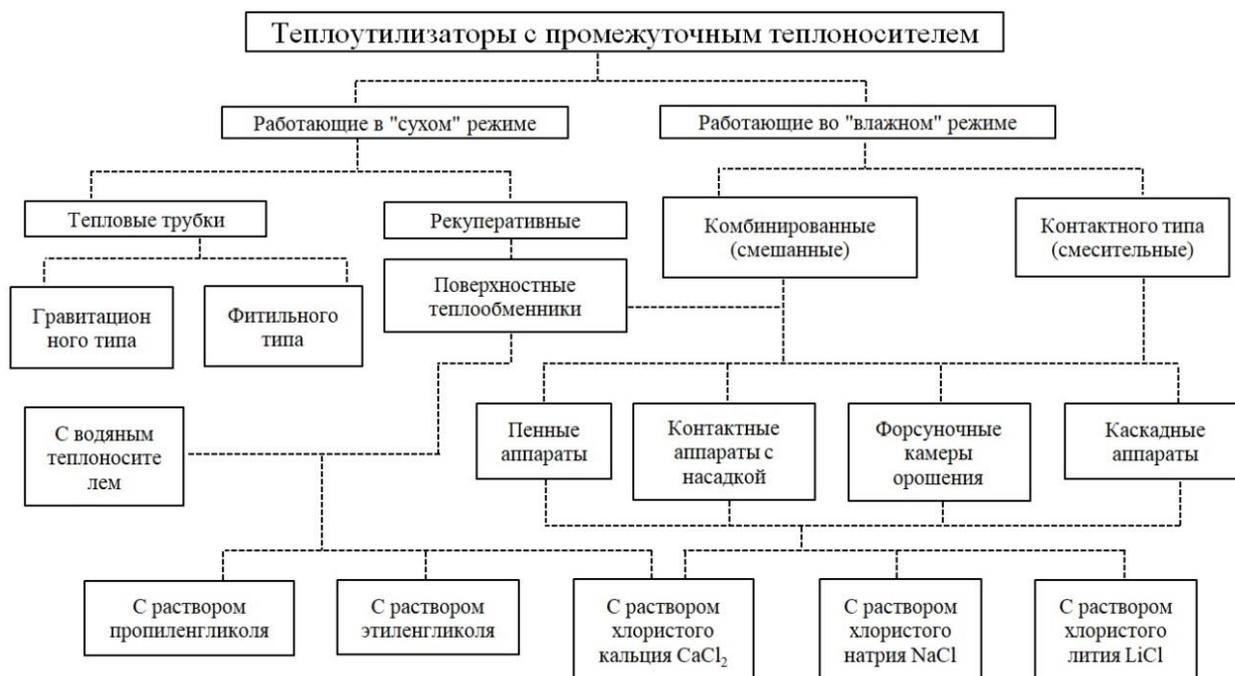
Рисунок 1.4 – Типы утилизаторов теплоты с промежуточным теплоносителем
