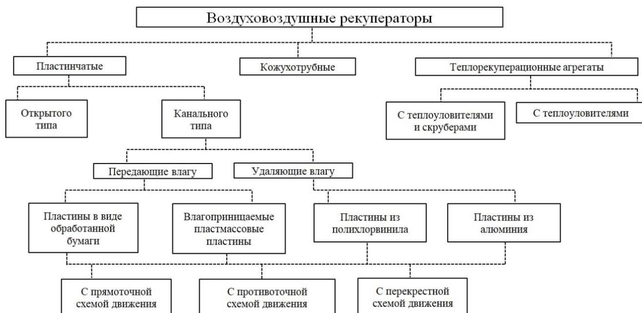
Рисунок 1.9 – Типы воздухо-воздушных рекуператоров
