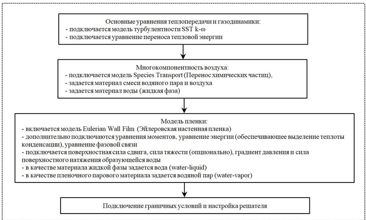
Рисунок 4.18 – Алгоритм подключения модели тепломассопереноса
