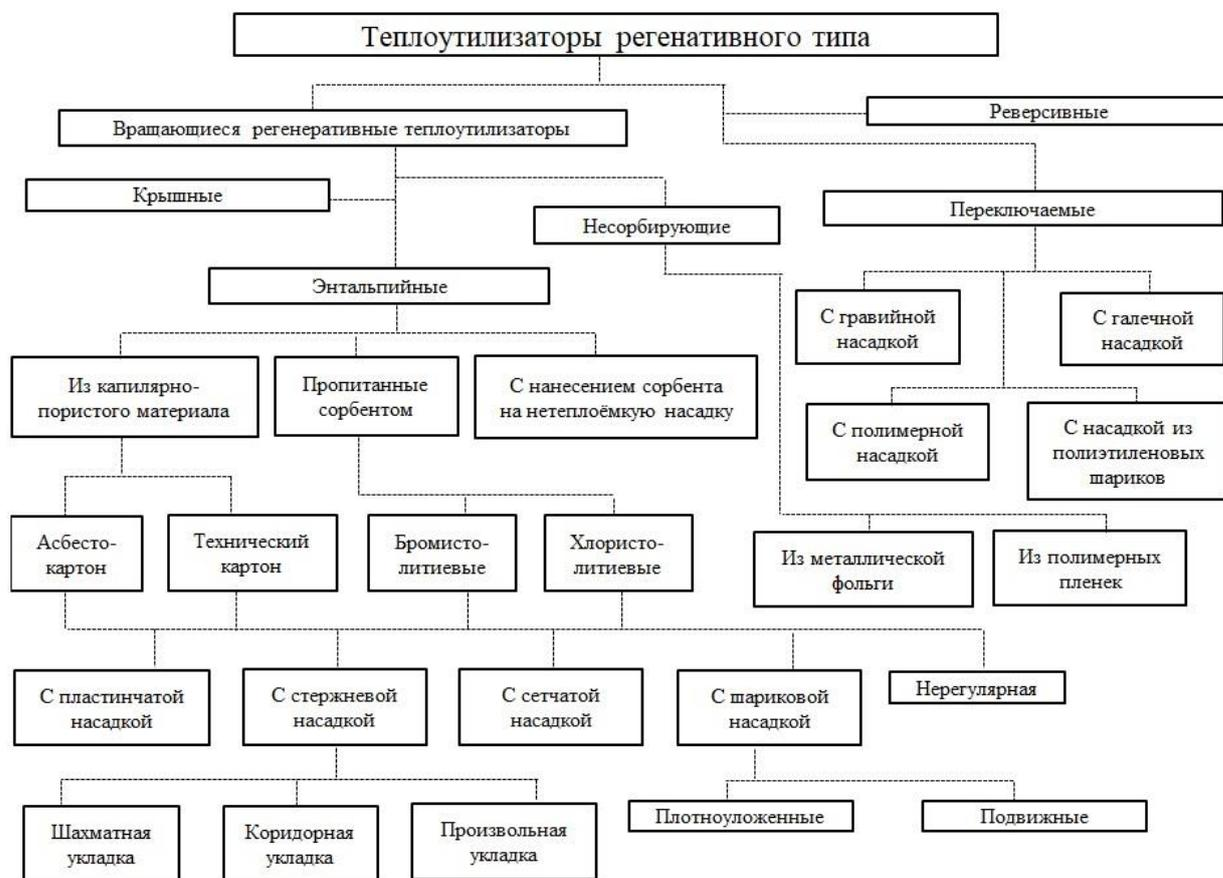
Рисунок 1.7 – Типы воздухо-воздушных регенераторов
