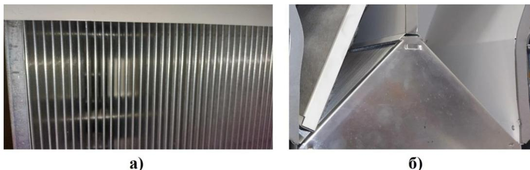
Рисунок 3.9 – Теплообменный блок рекуператора ISIS Recover HR-A-05-V-G4-E-1-60. а – массив каналов; б – общий вид теплообменника
